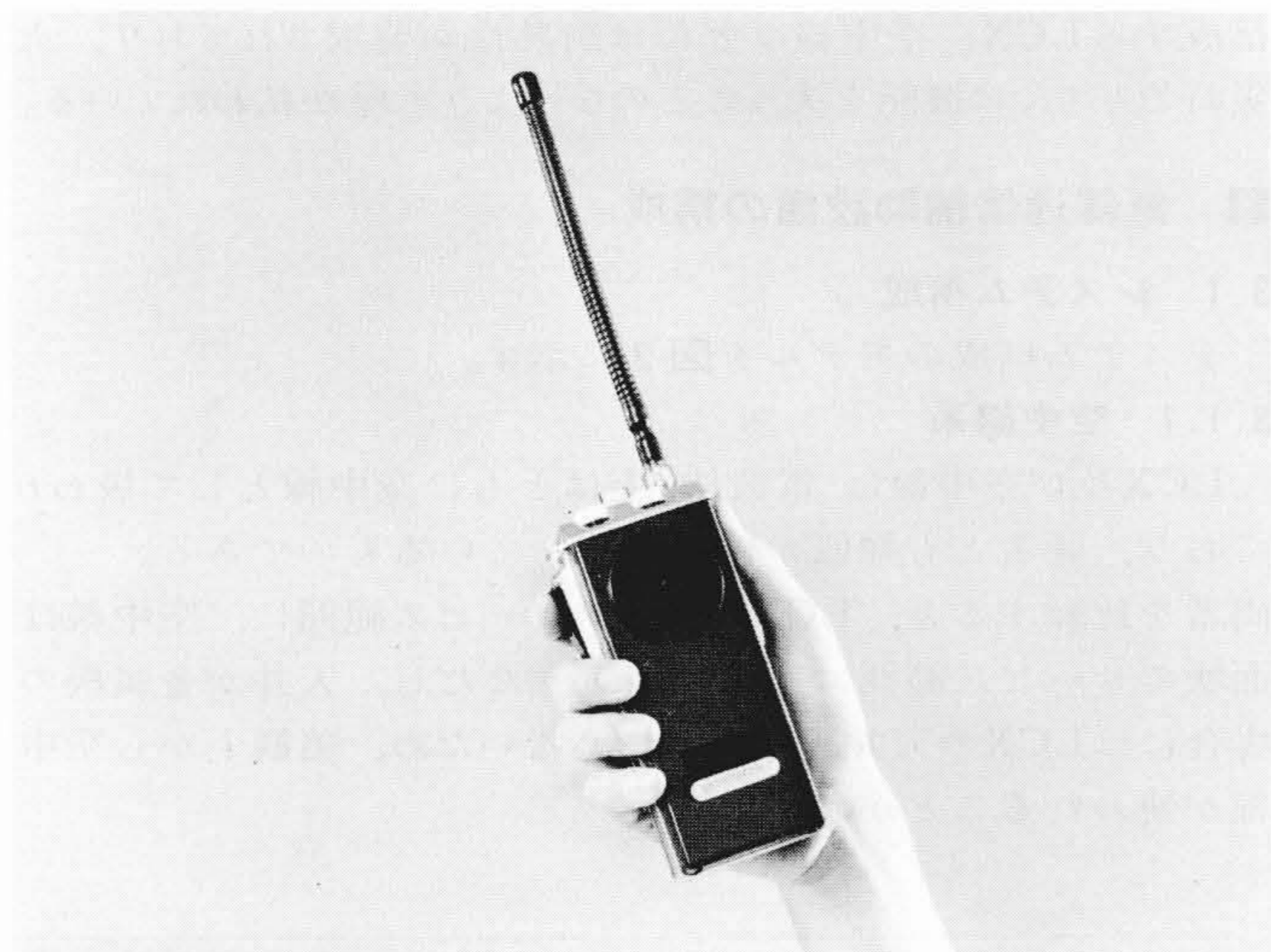
図3 携帯無線機EMM-0106形 出力1W、小形化されている。
