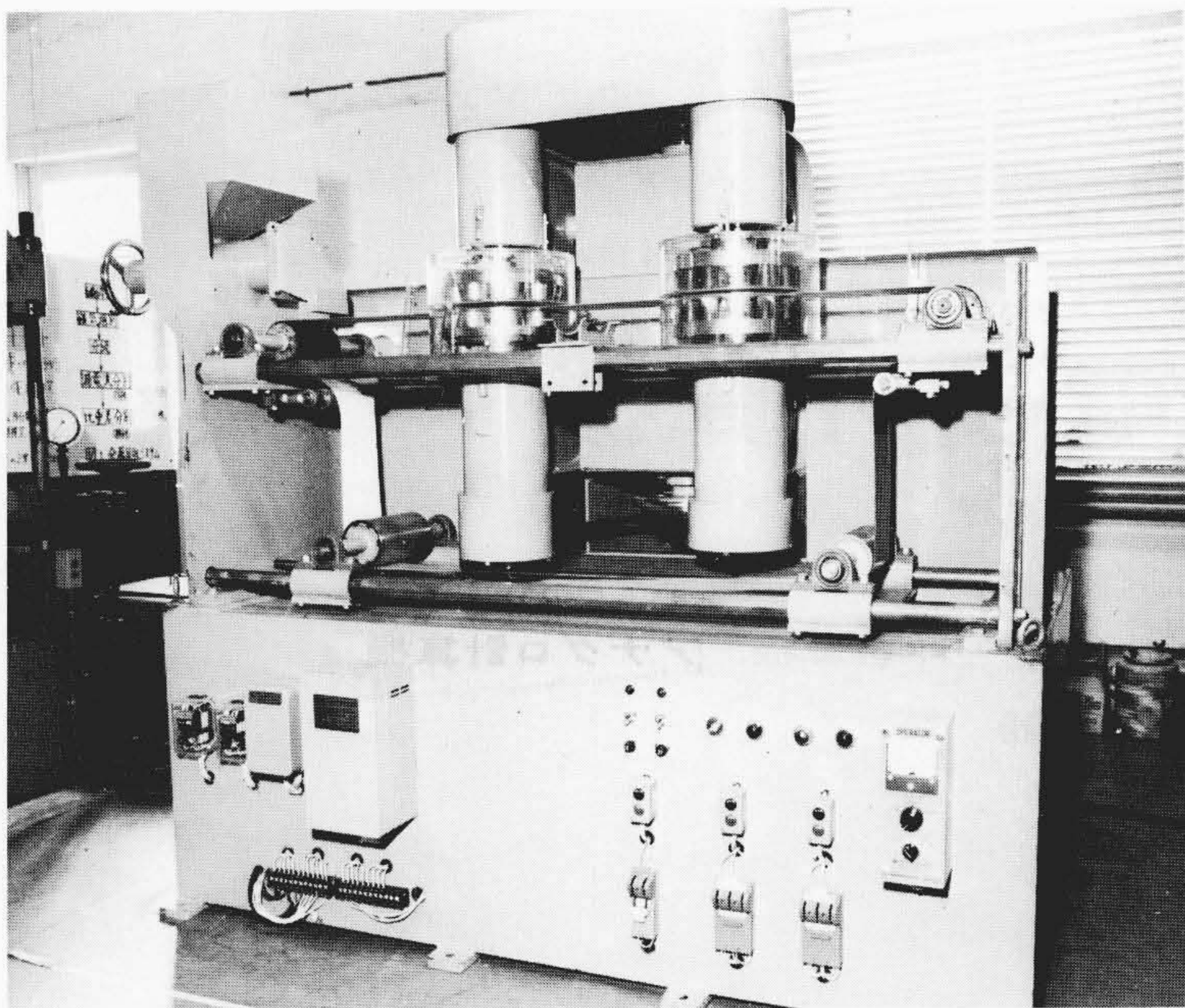
図13 うず電流による金属・非金属分別装置
