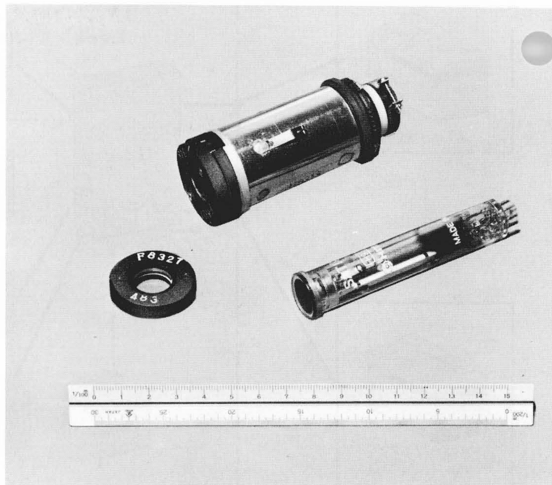
図1 18mm形「サチコン」H9311とバイアスライト光源F8327
