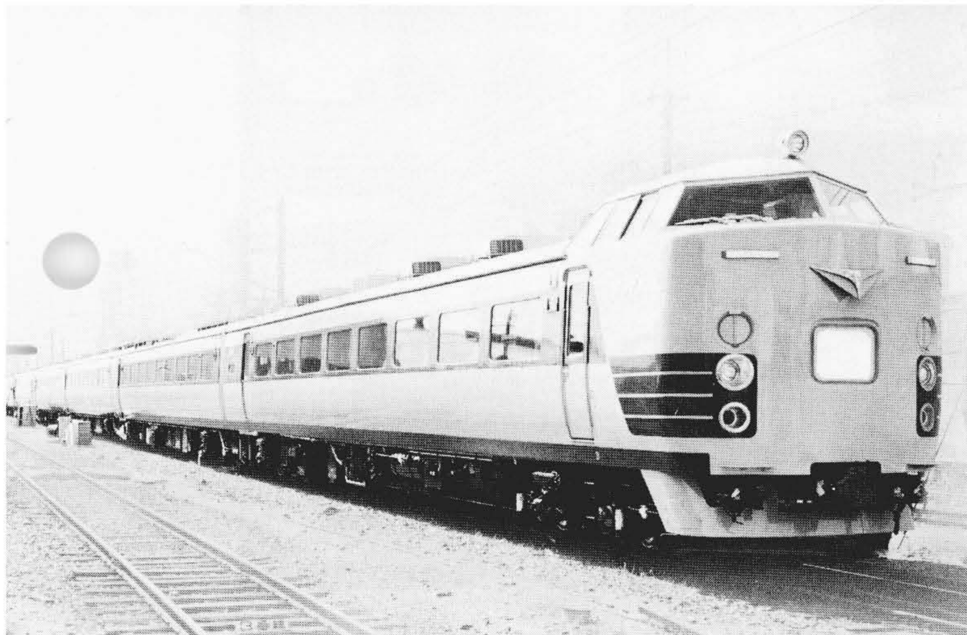
図2 日本国有鉄道納め485系耐寒耐雪形特急電車
