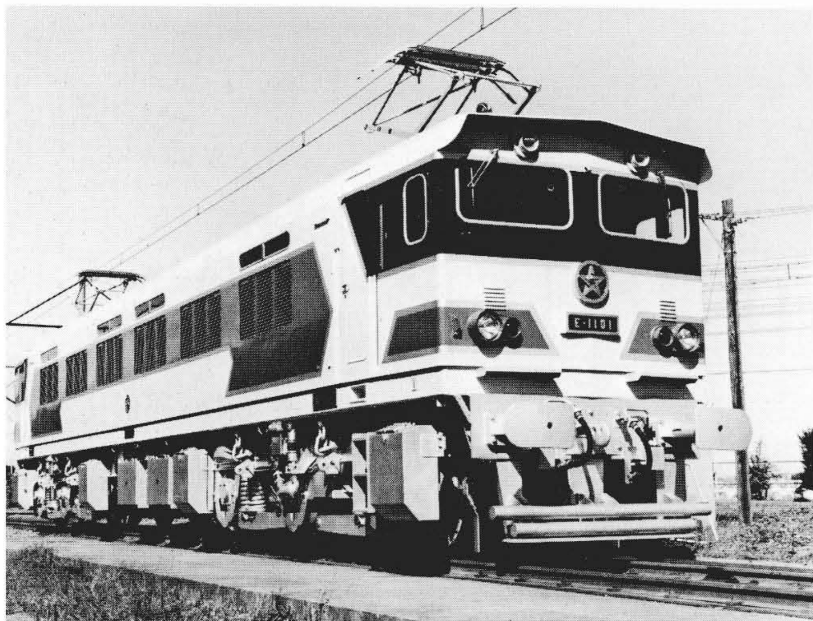
図5 モロッコ国鉄向け2,850kW直流電気機関車
