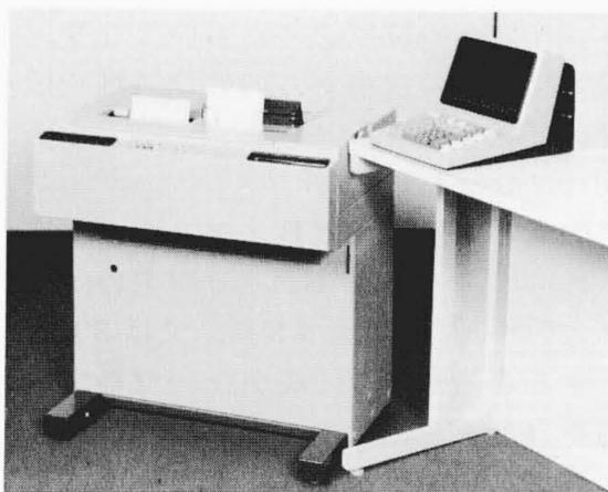
図1 日立モジュール形銀行端末装置の店頭用端末構成
