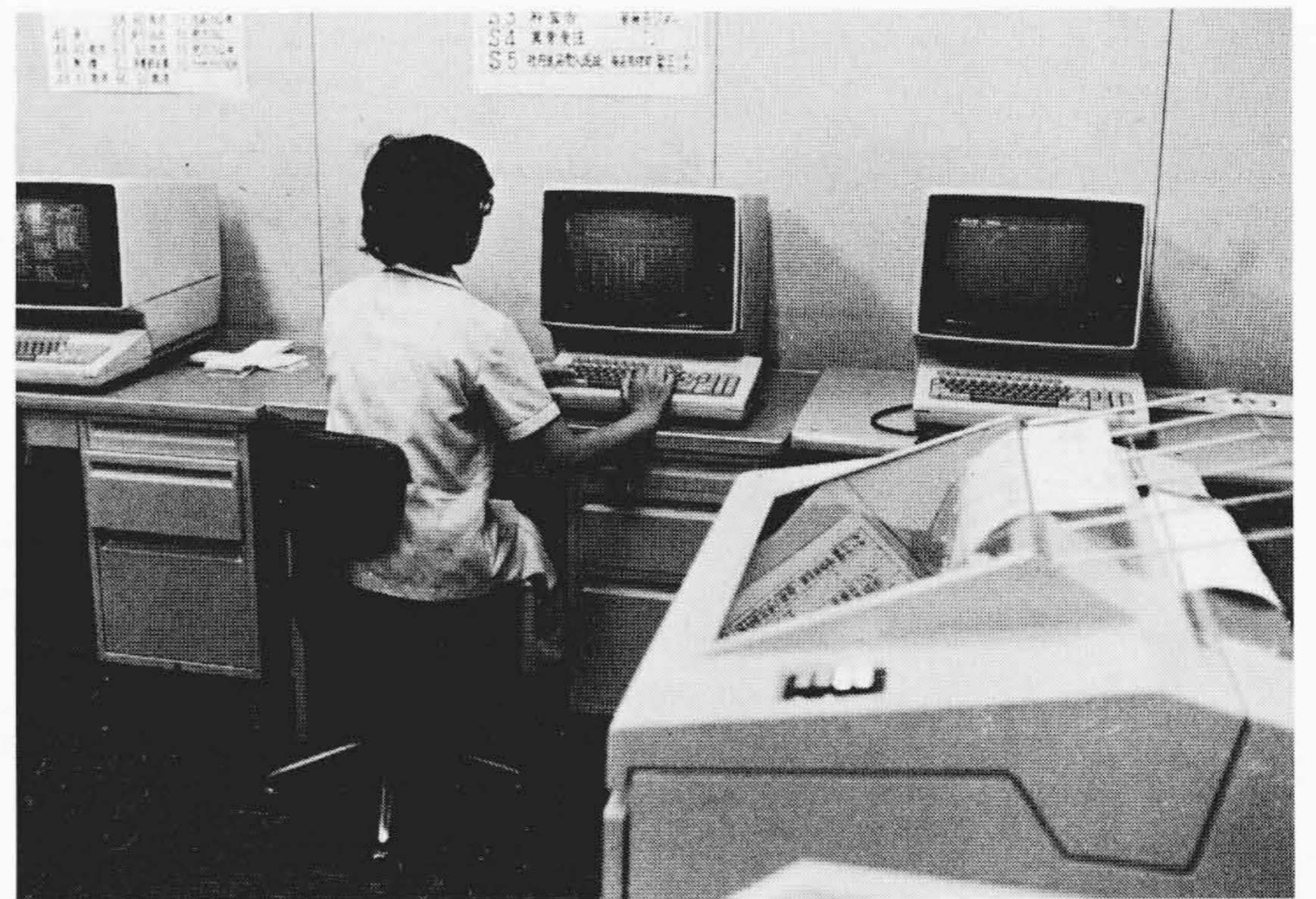
図1 H-9415VDSの外観 卓上形のコンパクトなVDTと、高速プリンタ(「はいたつく」'76.9より転載)を示す。
