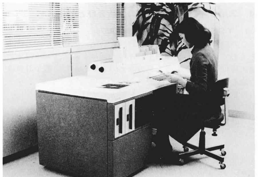
図3 HITAC 85オフィスコンピュータ 150字/秒、1行255字の高速、幅広プリンタを特長とし、RPG II言語によりプログラム可能なオフィスコンピュータである。
