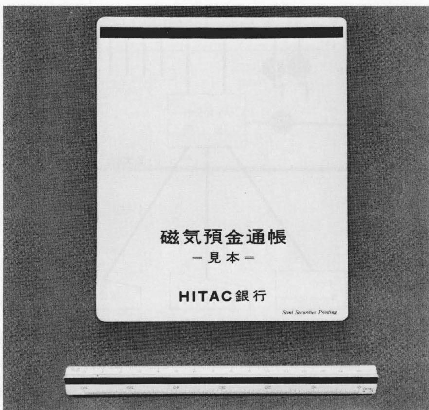
図3 磁気ストライプ通帳 通帳の裏表紙端部の磁気ストライプに書き込まれている口座番号、他のキー データが自動的に読み取られる。
