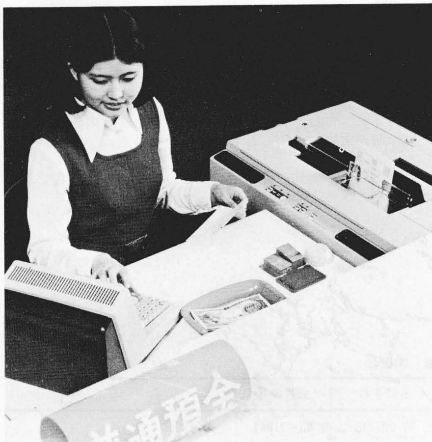
図7 T-5828モジュール形端末装置 写真は店頭用端末としての構成を示す。簡易操作盤(左)とプリンタ(右)で構成される。
