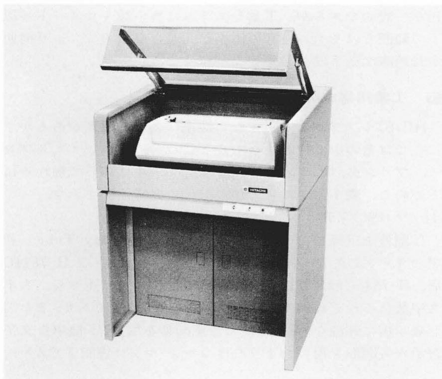
図1 H-7864C形プリンタ 大幅な電子化が進められた高速(30字/秒)プリンタで、防塵カバー付きのデスクに収納されている。
