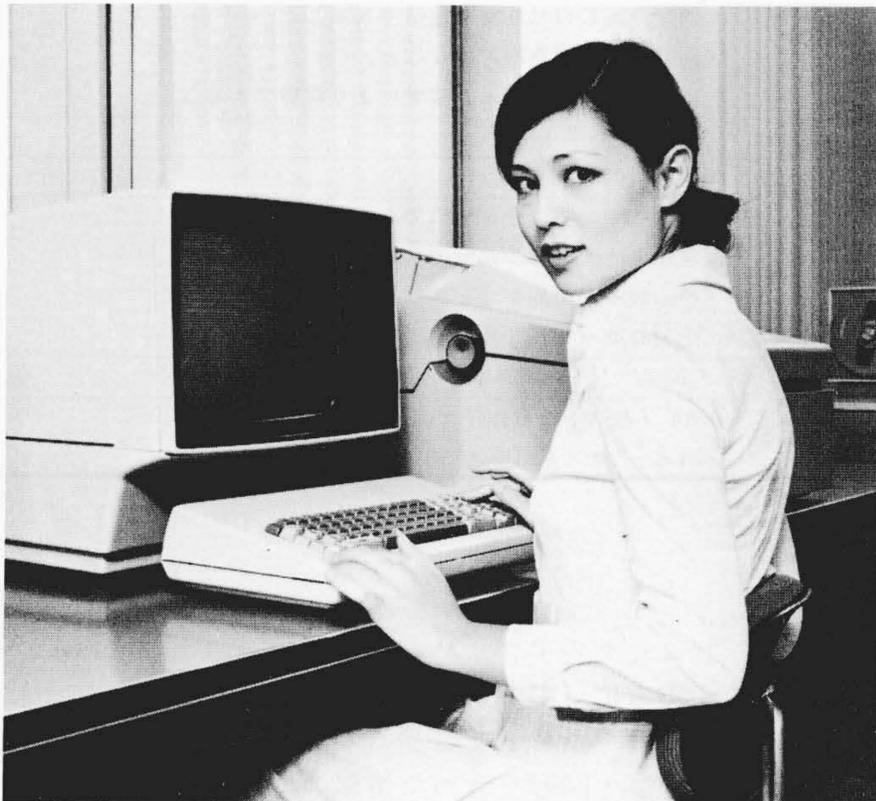
図5 HITAC T-560/40漢字ビデオデータシステム 表示文字数：480文字，16×18ドットマトリックス，表示文字種：4,096文字(標準)，磁気カード読取可能な漢字ビデオデータシステムである。
