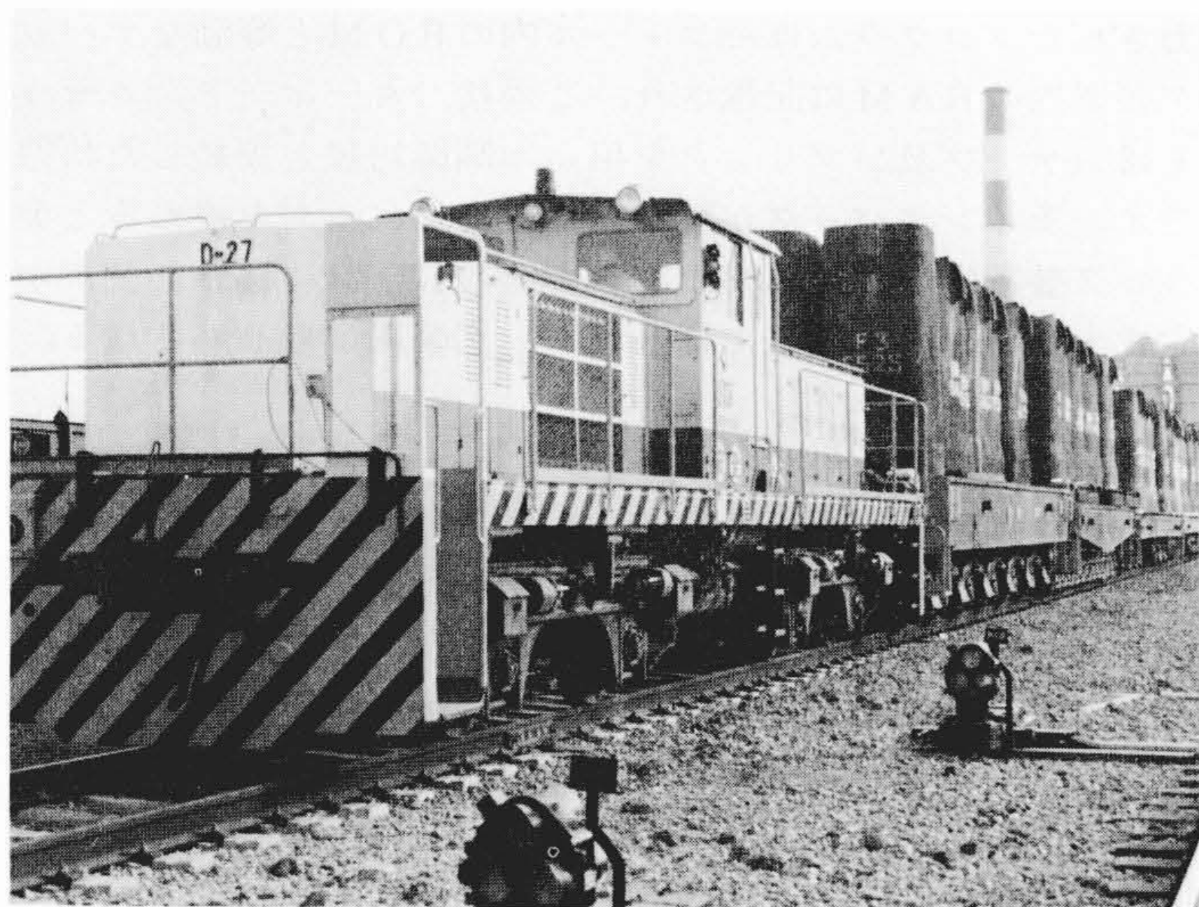
図5 ATOR走行性能試験 重荷重の引出しや走行制御性能で従来装置より大幅な改善がなされた。
