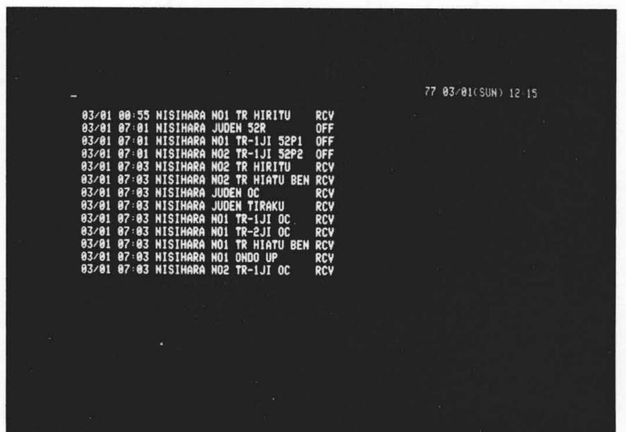
図13 CRTによる故障アナウンスメント例 CRTにより故障種別を発生時刻、回復時刻とともにアナウンスメントしており、従来の故障表示器による方式よりマンマシン性の良い対話ができる。
