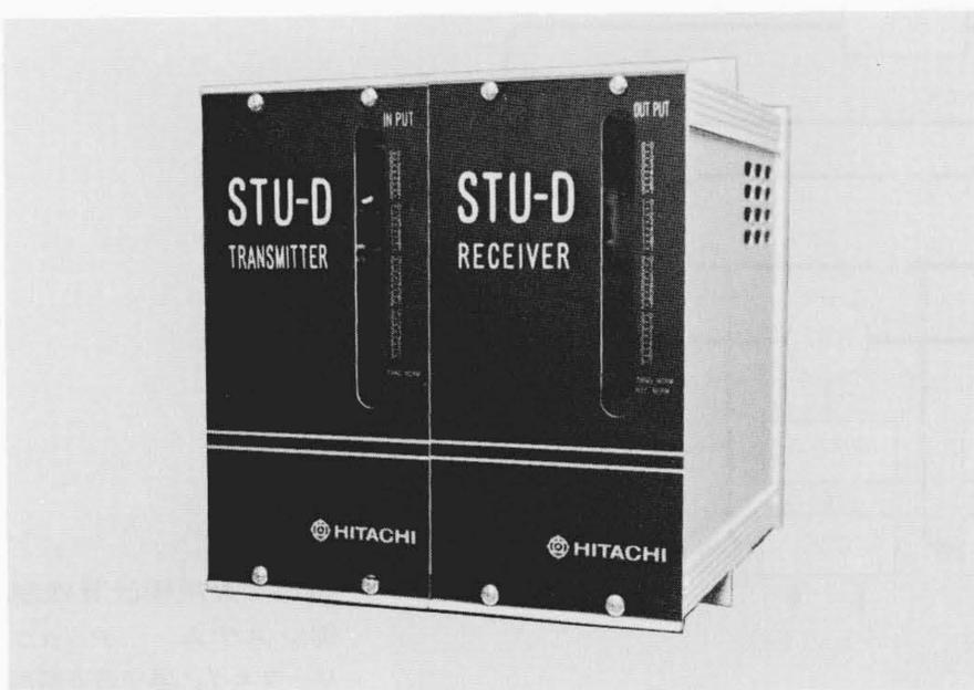
図4 STU(Signal Transmission Unit) 時分割多重送信/受信を用いた信号伝送装置で、1本のケーブルで32点伝送できる。
