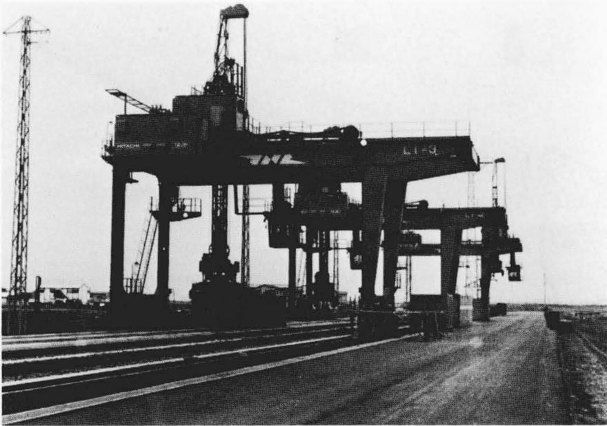
図4 触覚付きコンテナクレーン 触覚センサによりスプレッタ(つり具)を制御し、コンテナ荷役を行なう。
