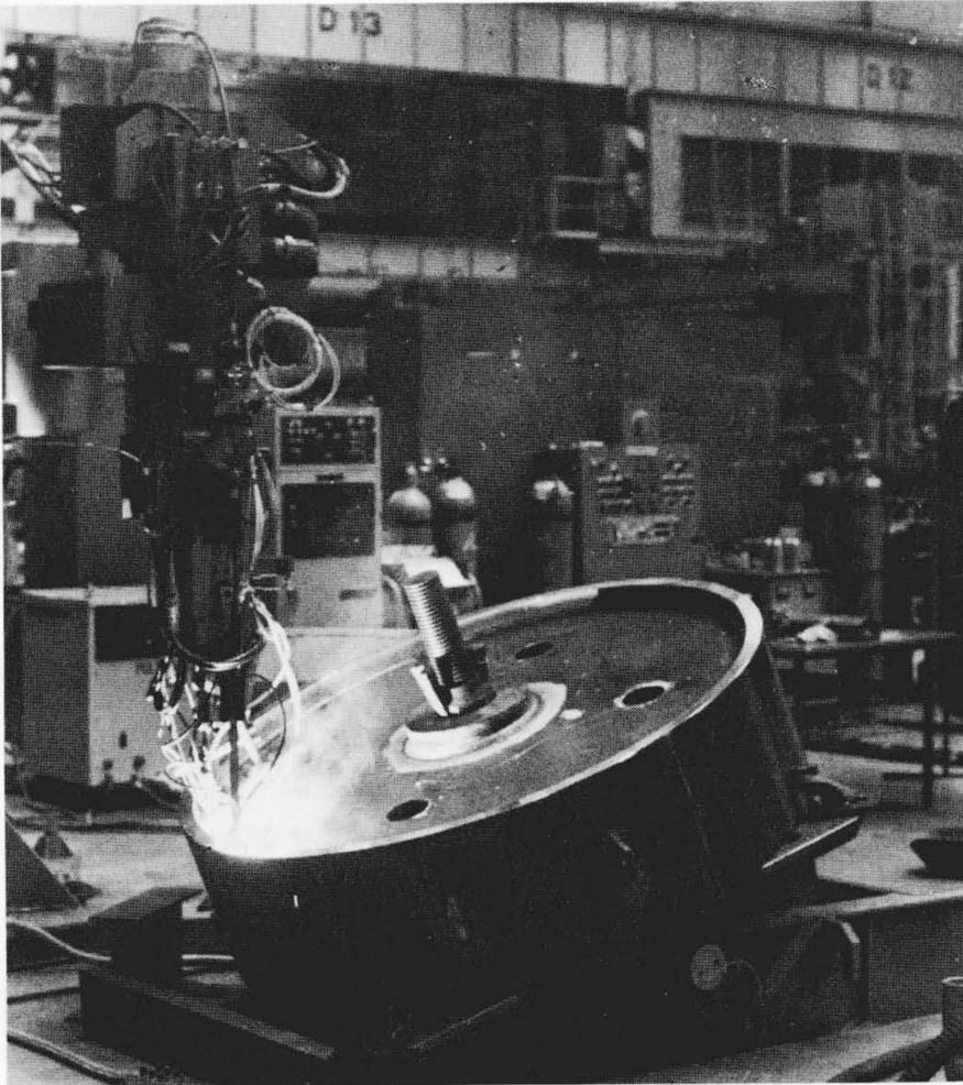
図8 ケーシングの溶接中の多層自動溶接機 ビードの高さを検出し、その値に基づいて溶接電流、電圧、ウィーピング幅などの溶接条件を決定して、パルスMIG溶接を行なっている。
