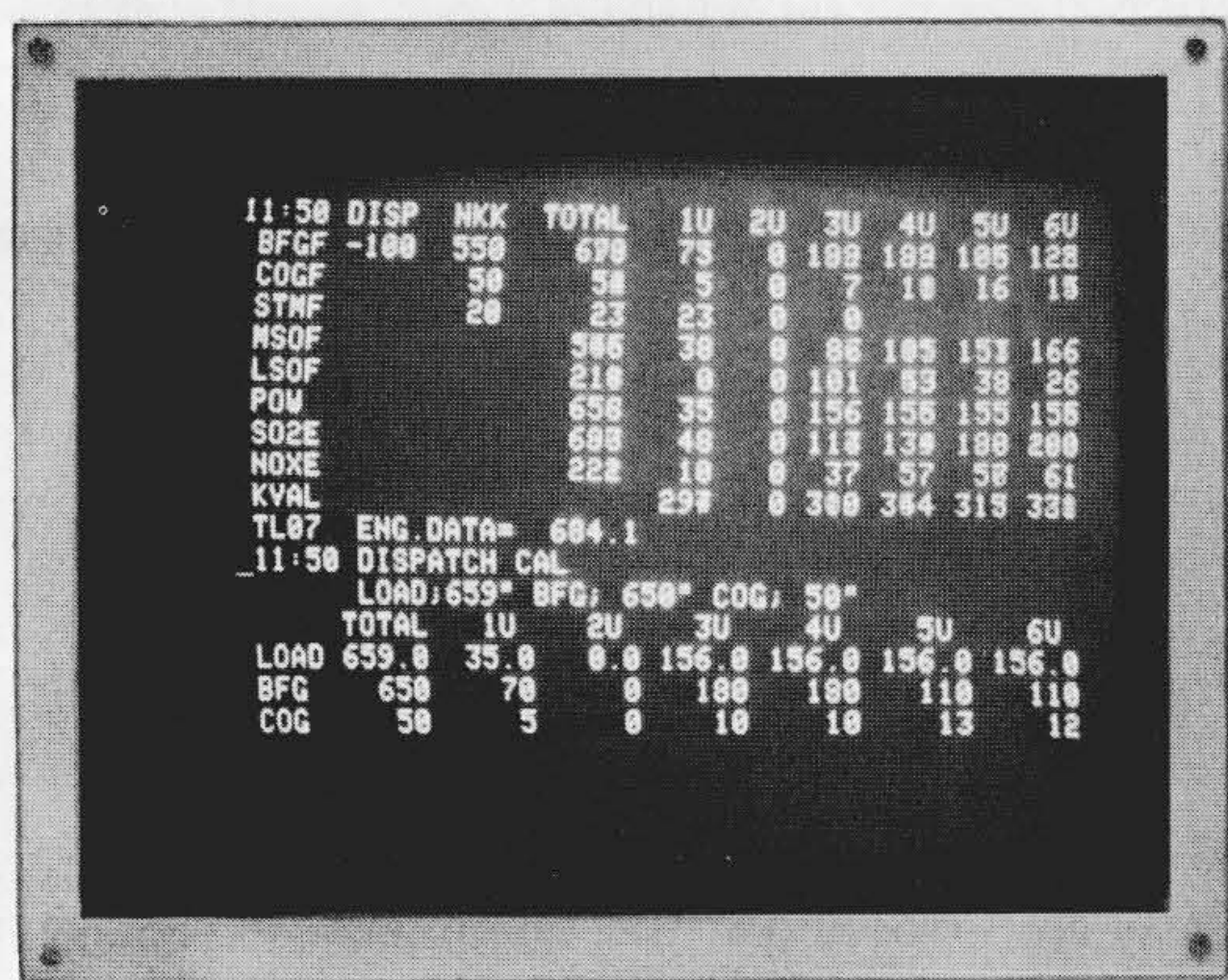
図6 CRT表示画面例 CRT表示画面の上半分には常時プラント情報を集約表示し、下半分はキーボードとの組み合わせにより、会話形式のマンマシンインタフェースを処理する。
