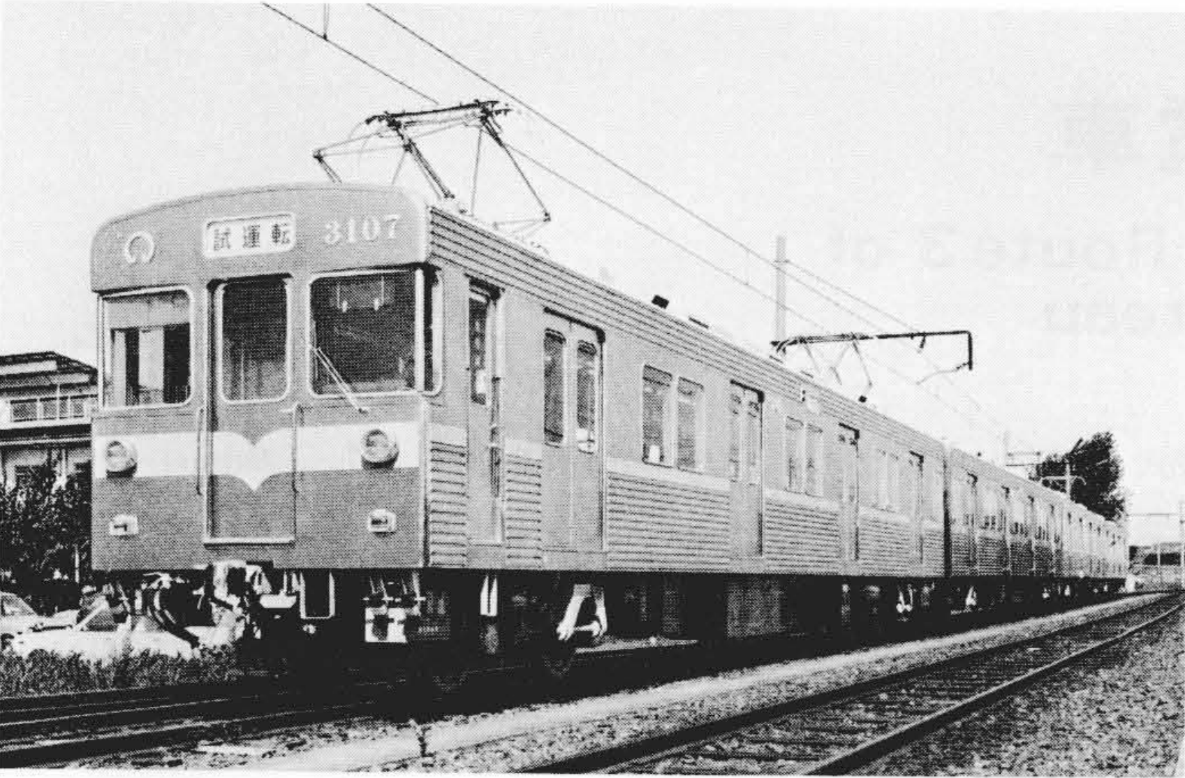
図1 3000形チョッパ制御電車 先頭よりMc1-M2-M1-Mc2車の4両編成となっている。
