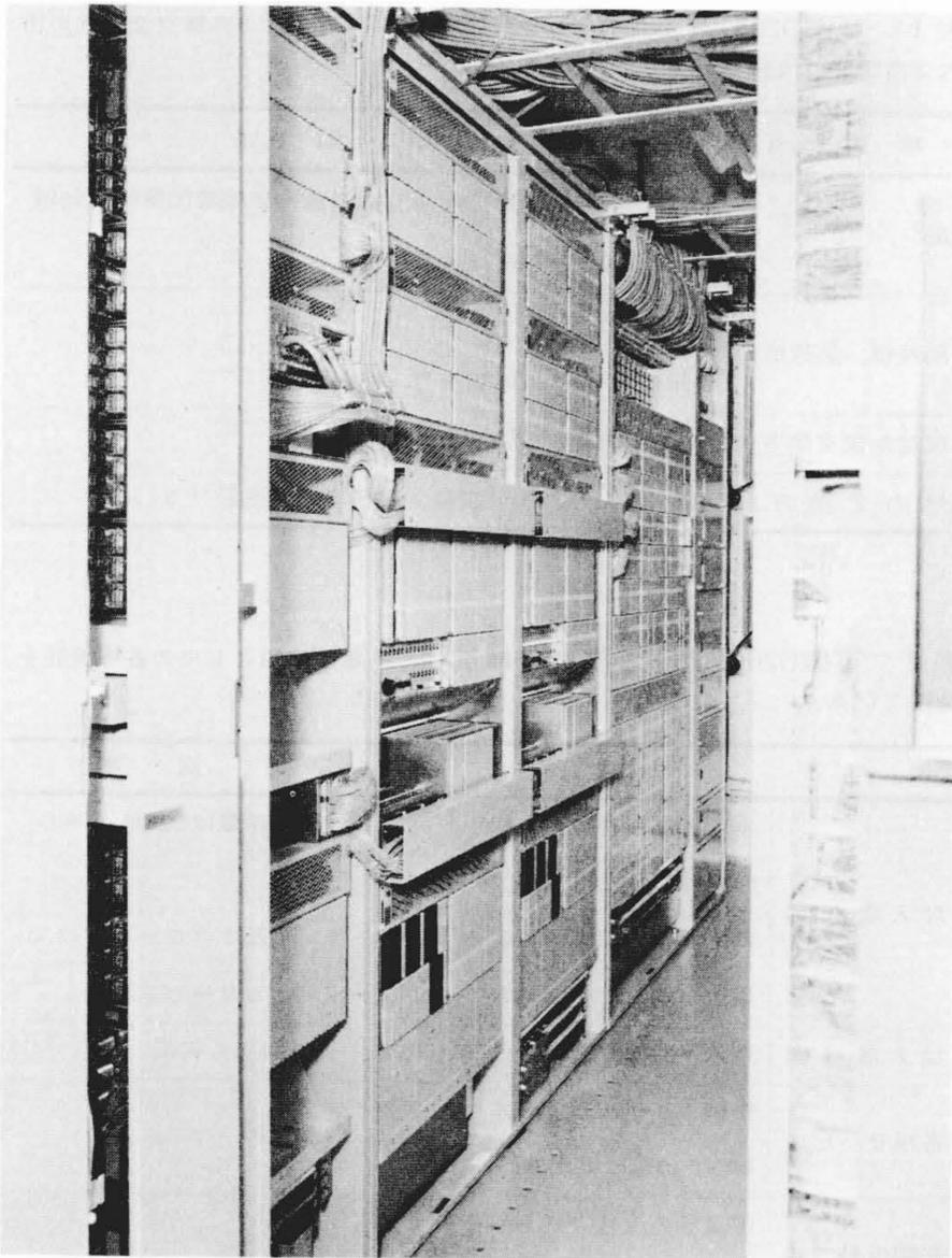
図6 可搬D20形電子交換機(基本ユニット)内部 入口より制御系の架を見たところで、奥からPOWF, SPCF, CPFと配列されている。CPF下部には磁気バブルメモリが実装されている。
