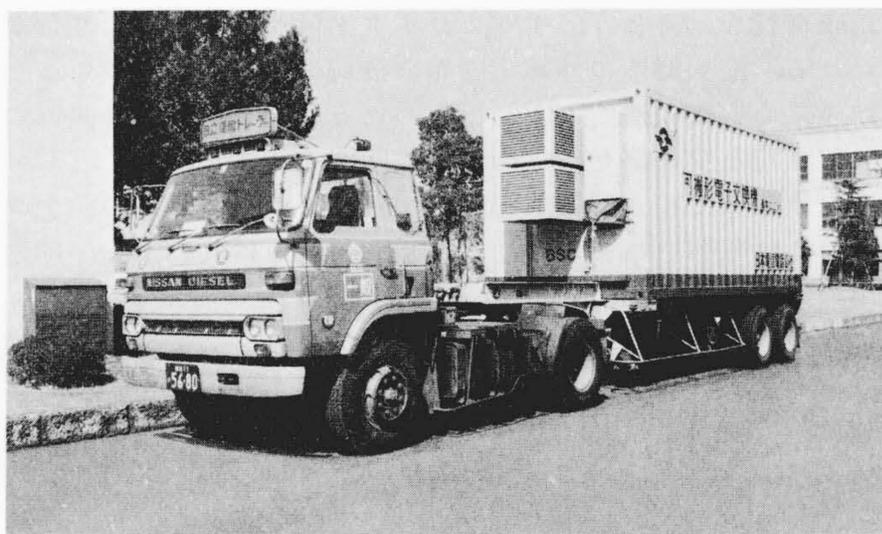
図1 可搬D20形電子交換機(基本ユニット)外観図 一般の海上コンテナ用セミトレーラに搭載して輸送中の状態を示す。
