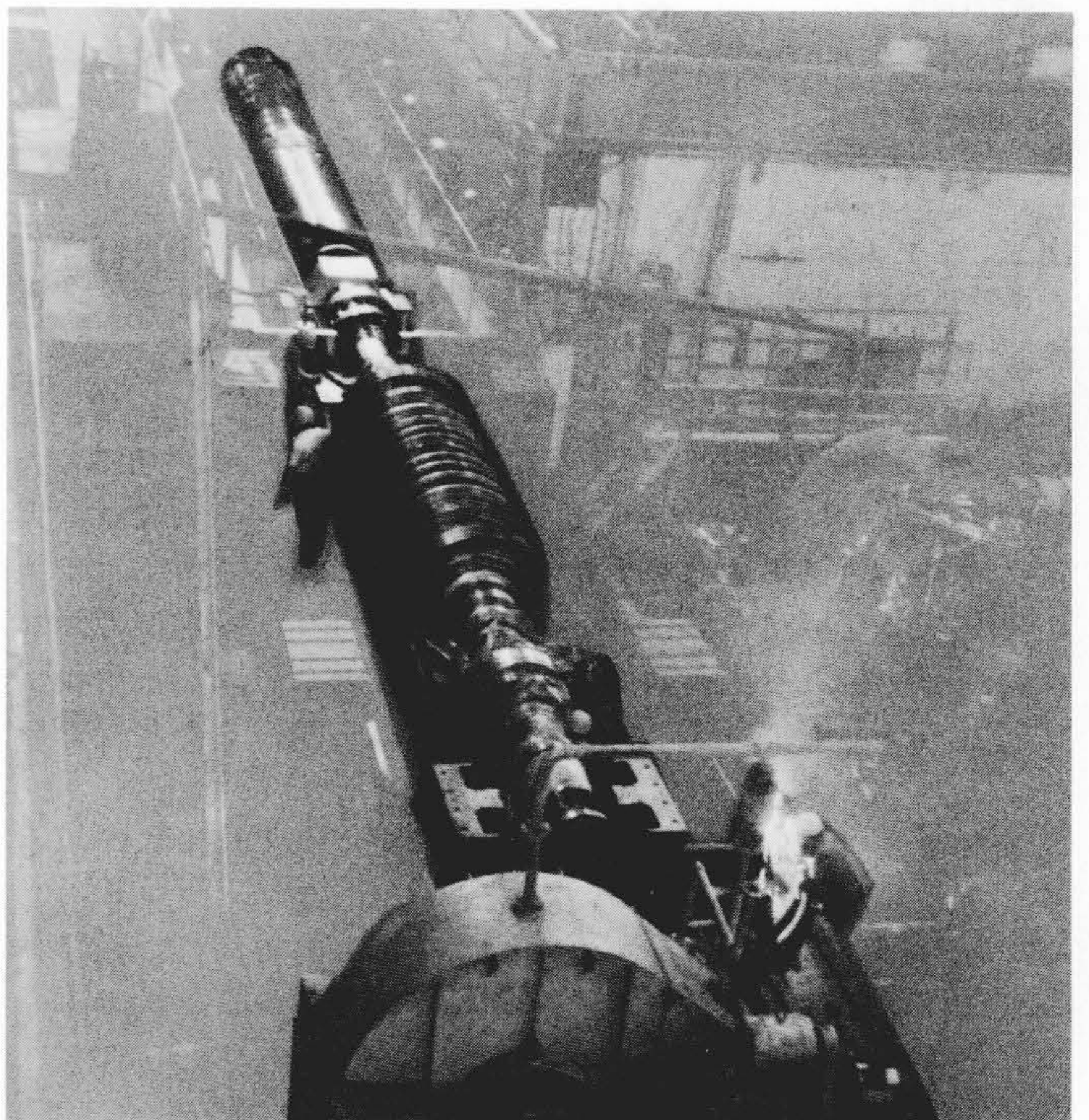
図8 工場内の低圧タービンと発電機軸の直結試験(組立中) 低圧タービンと発電機の直結の問題、軸受に基づく振動、ラビングによる振動など、実物大ロータによる軸振動解明実験を行ない振動要因と振動現象の特徴について調査した。
