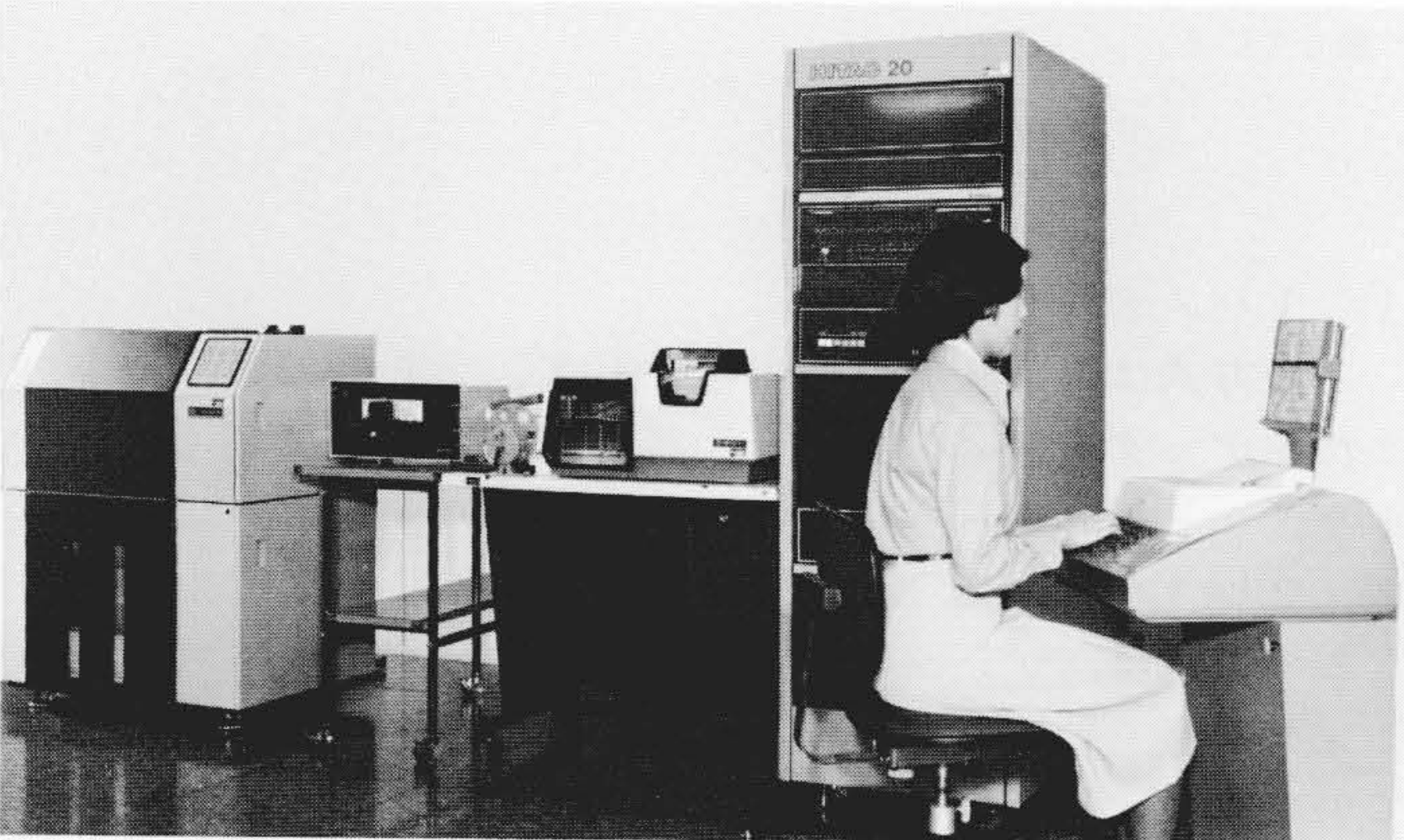
図11 分析データ処理におけるコンピュータシステム 日立製作所中央研究所分析センタでの会話型オンラインデータ処理システム中枢部のHITAC 20コンピュータシステム部分を示す。
