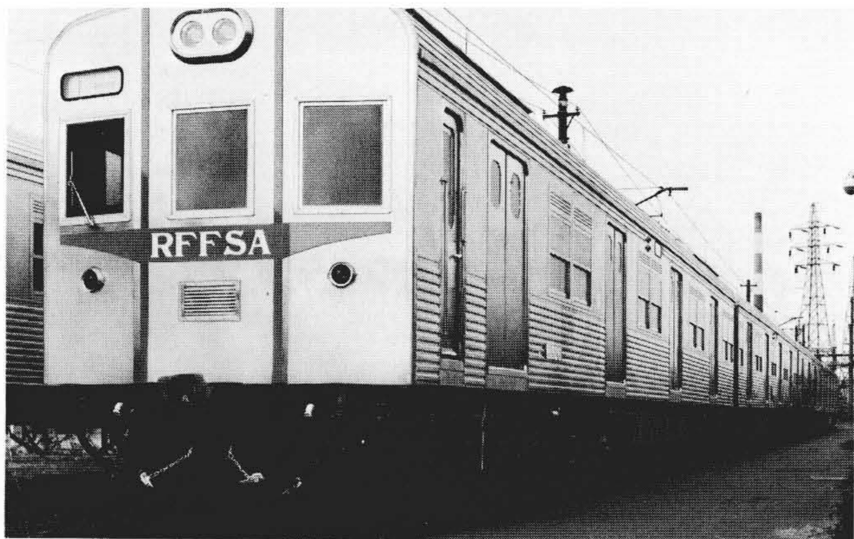
図5 ブラジル連邦鉄道納め直流3,000V全ステンレス鋼製電車の外観
