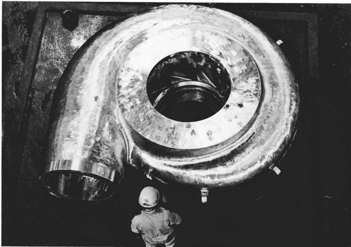
図11 加圧水型原子炉用再循環ポンプケーシングの製造
