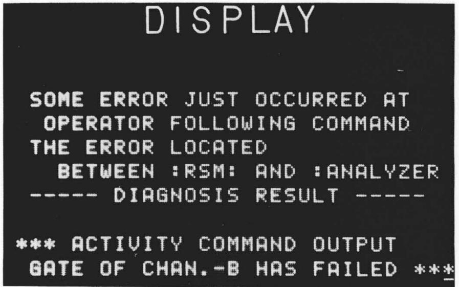
図7 故障診断装置の表示例 故障位置のプラズマ文字表示により、故障除去処理を短時間に行なうことができる。
