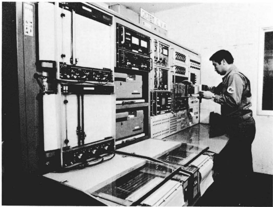
図12 振動解析装置 圧縮機の工場試験で各部の振動は、リアルタイムアナライザにより分析され、また、圧力や温度などの条件とともに記録される。
