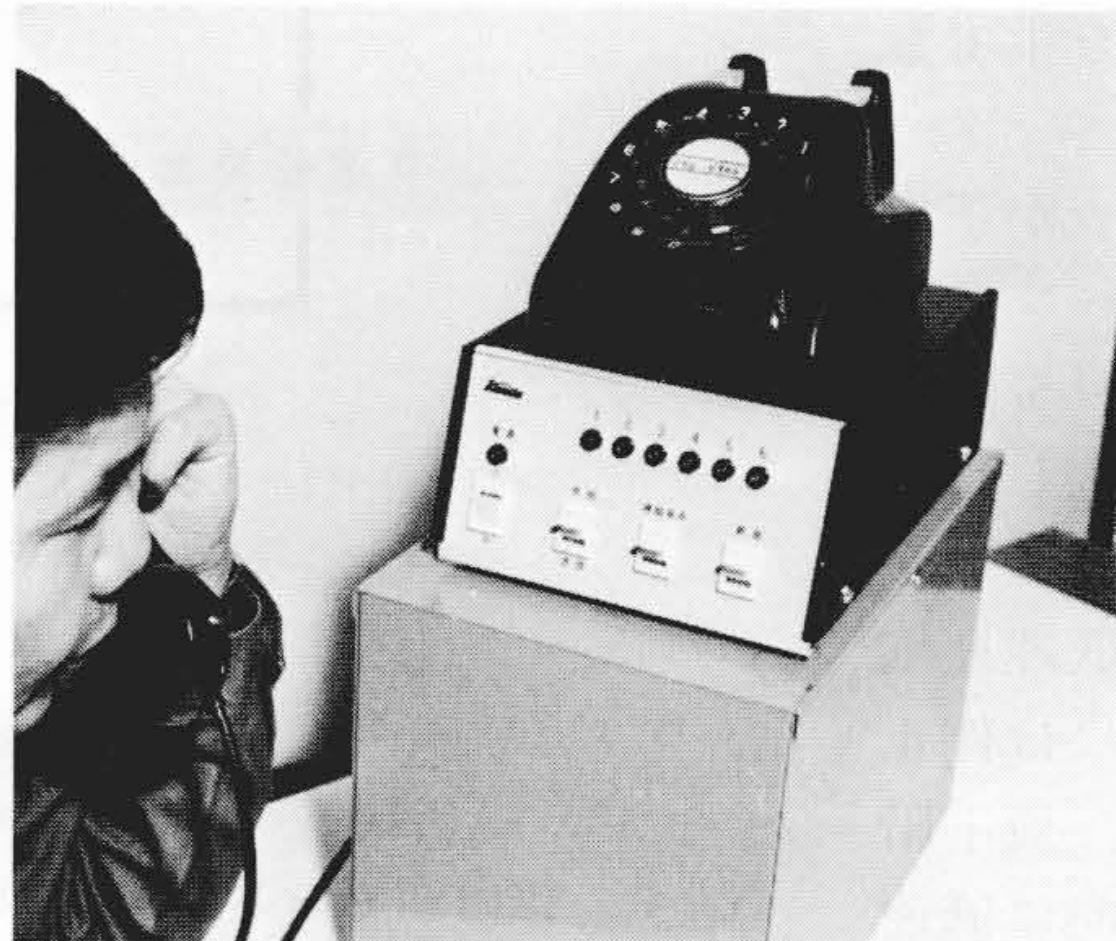
図6 自動通報システム受信器(6回線)のテスト状況 識別ランプ表示により、故障エレベーターの所在が容易に判別できる。1局当たり100回線の設置が可能である。
