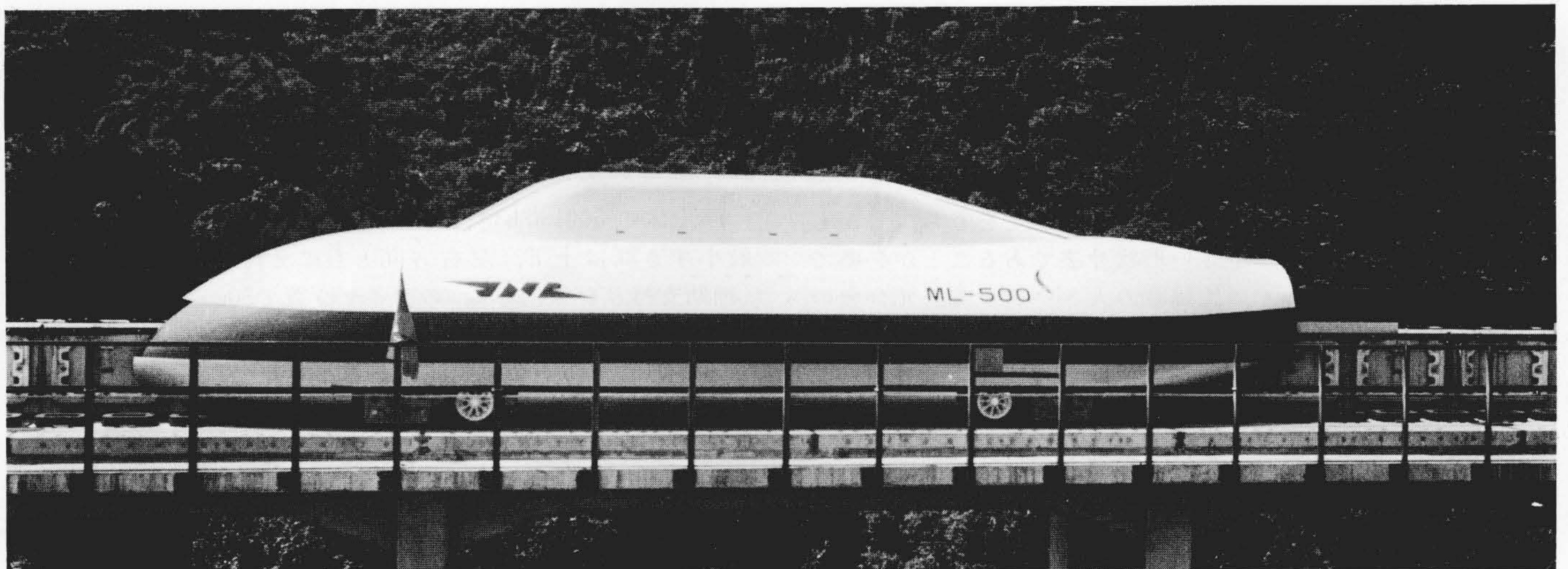
図1 浮上体の外観 浮上体は、長さ13.5m、高さ2.9m、幅3.72mで質量は10tであり、また軌道は全区間高架である。
