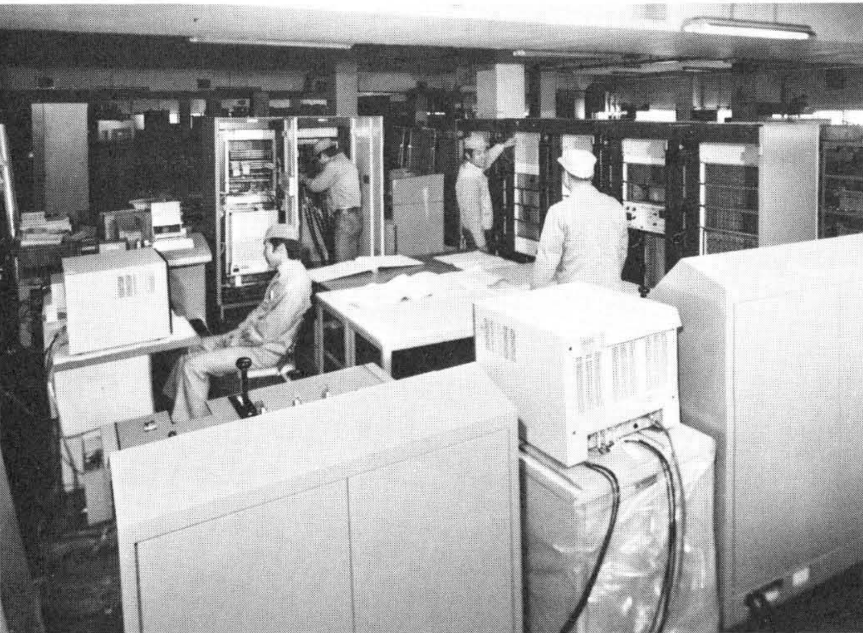
図2 中央制御装置の工場内試験状況 中央制御装置は、HIDIC 80 計算機と専用制御装置とで構成され、両者は密接な連動がとられている。
