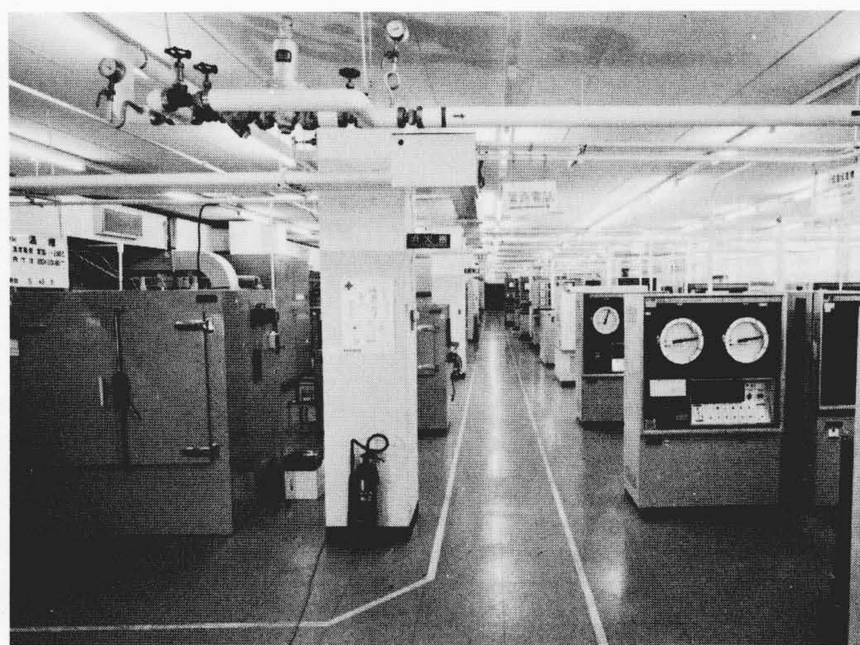
図9 寿命試験/エージング用設備 部品の認定、ロット保証及びエージングを行なう。
