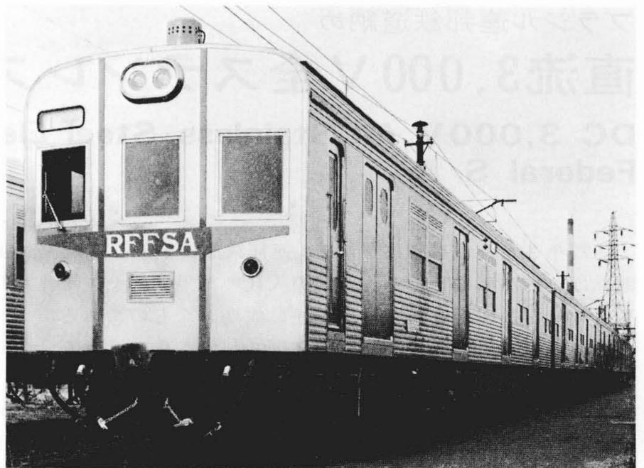
図1 電車外観 外板はステンレスNo. 4仕上げとし、前面には略称入りの飾帯を付けている。
