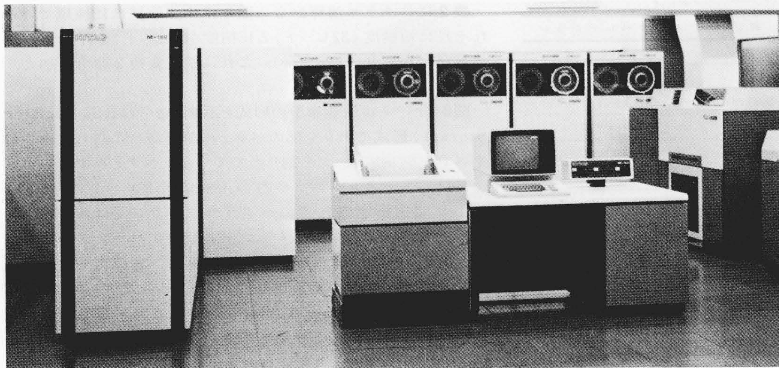
図 1 HITAC M-180 中央処理装置 1 台につき、最大 16 MB の主記憶装置、最大 16 台のチャネル装置でシステムを構成できる。
