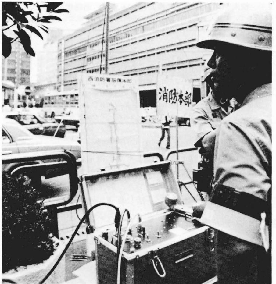
図8 消防無線用可搬形自動中継器 地上系と地下系無線信号の自動中継機能のほかに、この中継器が指揮本部となって地下及び地上と交信することもできる。
