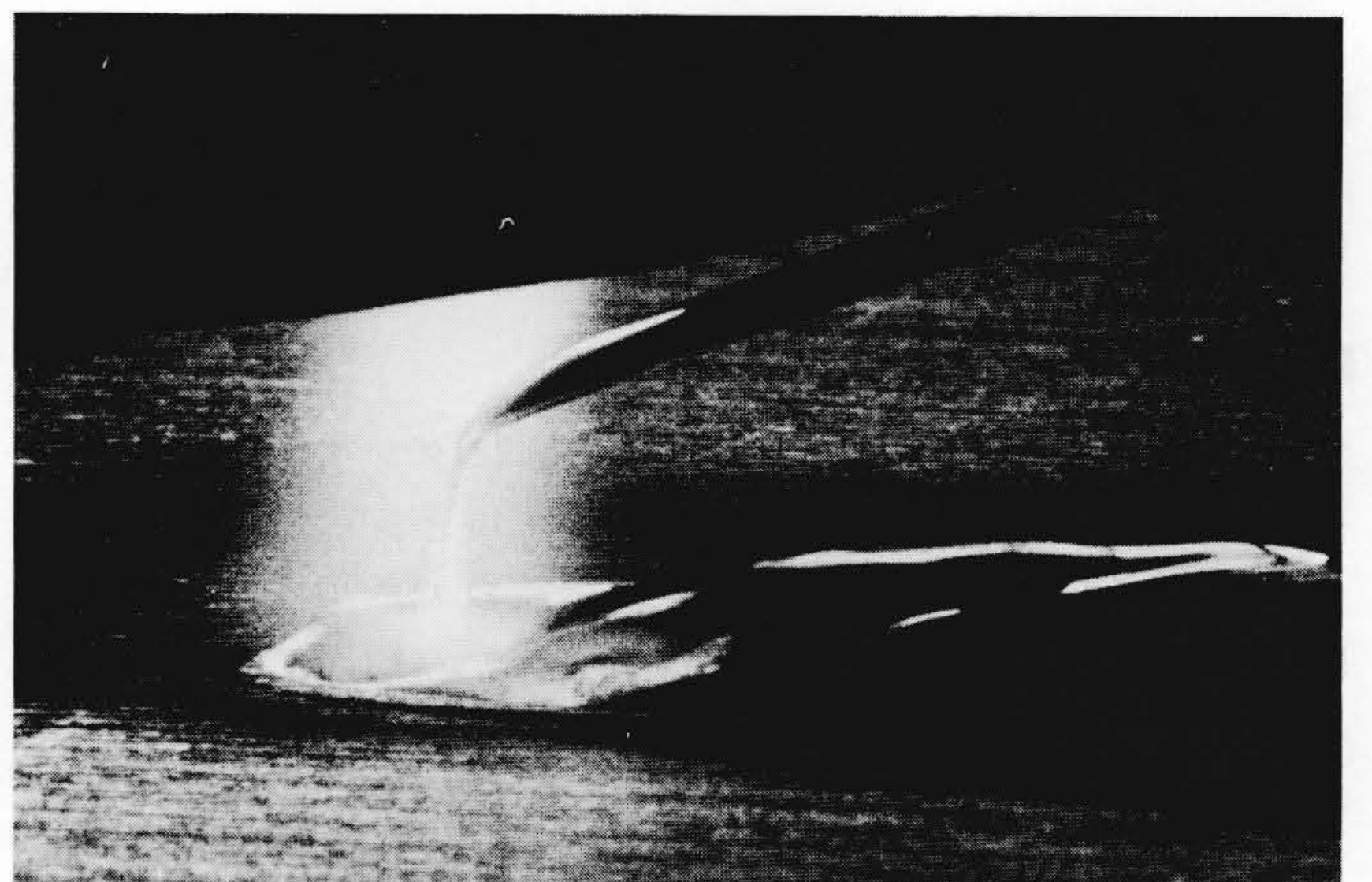
図5 ワイヤ通電方式「プラズマペア」の溶接アーク プラズマアーク中に送給されるワイヤは通電されており、ワイヤから発生するアークによって溶融され、プラズマジェットによって吹き曲げられて水流のように溶融プール内へ移行する。
