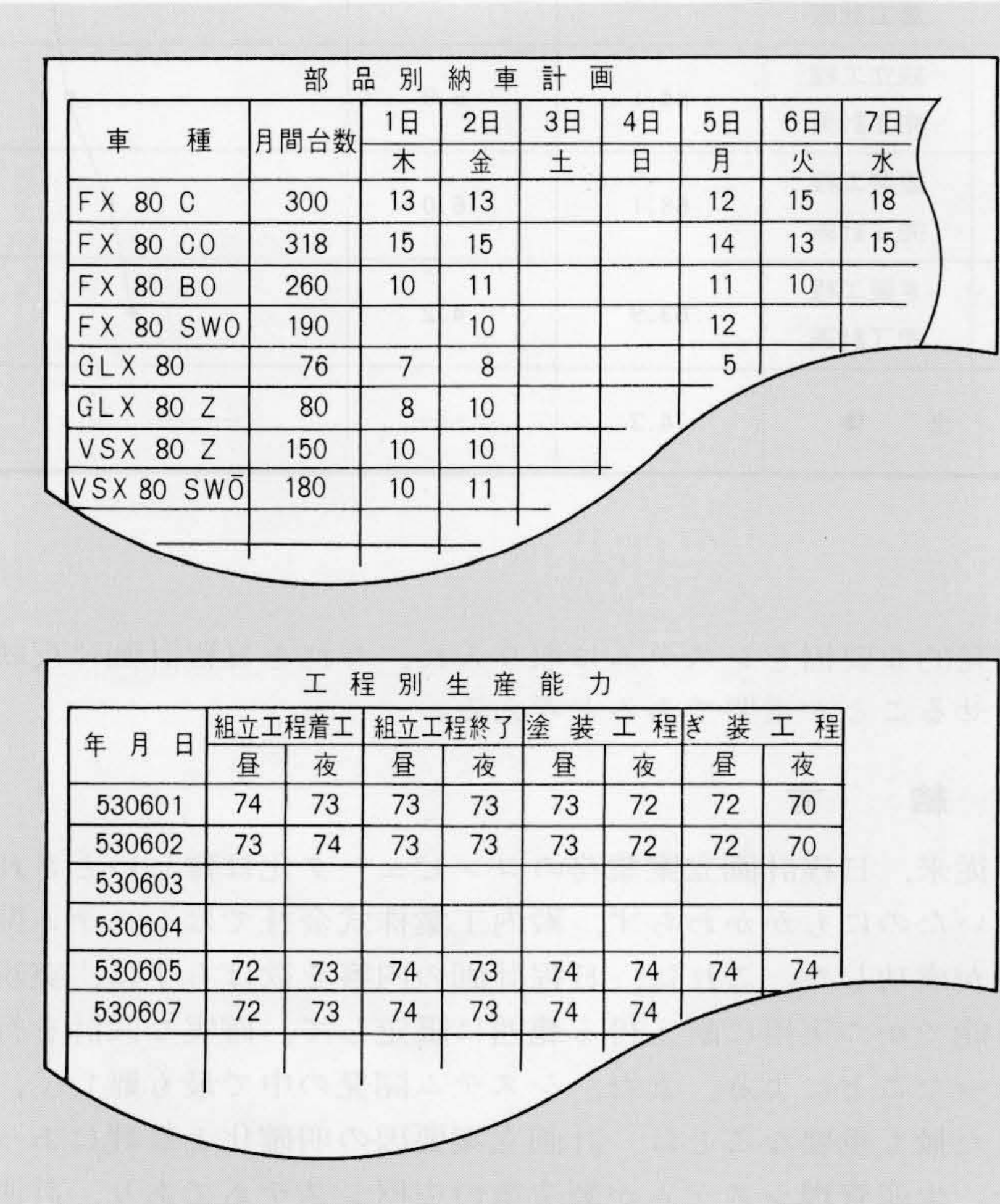
図3 スケジューリングシステムの入力情報 スケジューリングシステムの入力情報は、納入先から示めされる要求データと工場生産能力情報である。
