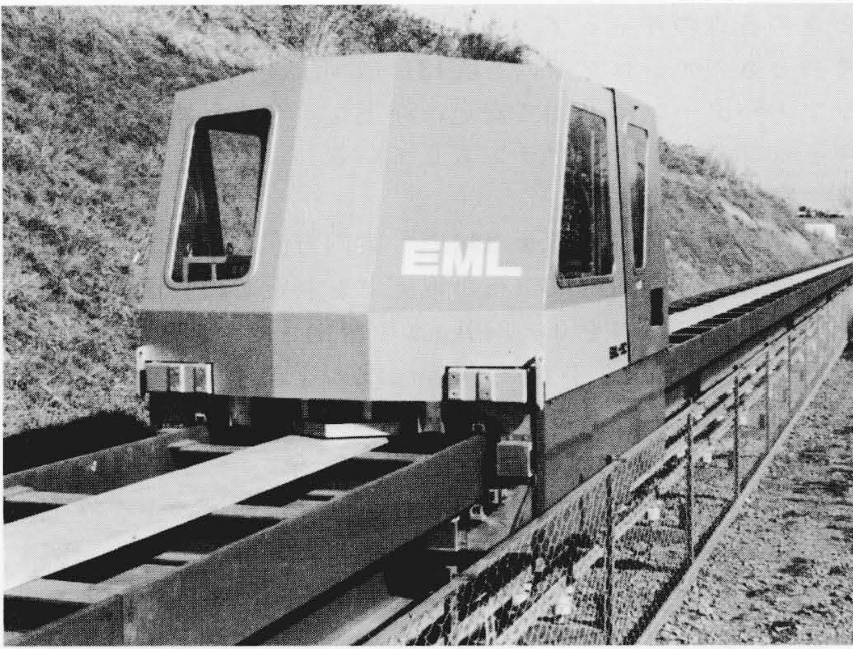
図11 実験線の全景 実験線の全長は約165m、実験車両の重量は1.8tである。
