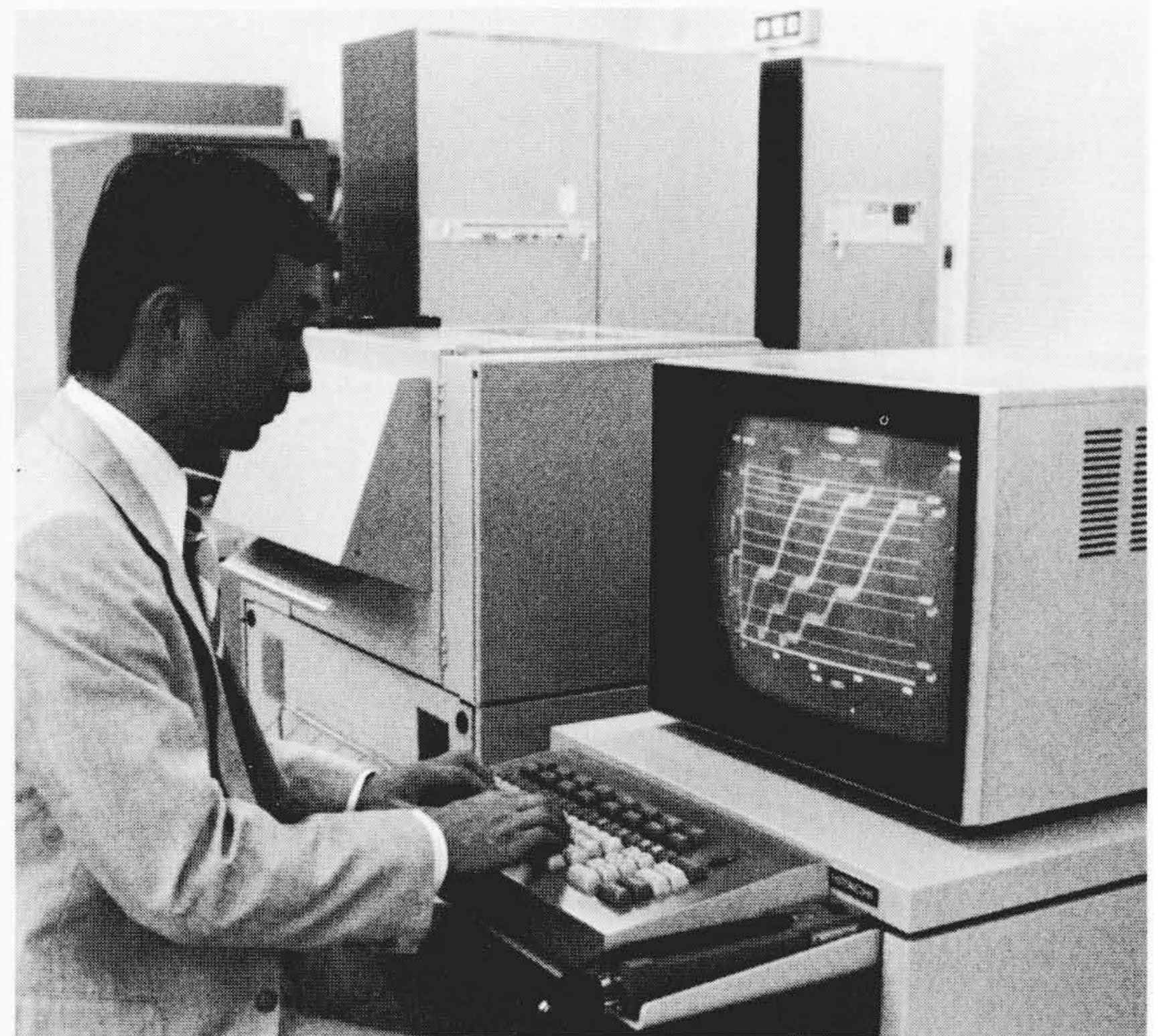
図8 ディスプレイを介しての会話形設計 設計者はキーボードによりシミュレーション条件を設定し、すぐにシミュレーション結果を確認評価することができる。
