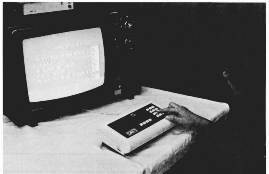
図3 端末のレイアウト例 簡易なキーボードを使って、だれでも簡単な操作でセンタと会話し、必要な時に必要な情報を入手することができる。一般のテレビジョン受像機に映し出された映像は、必要に応じハードコピーに取ることもできる。
