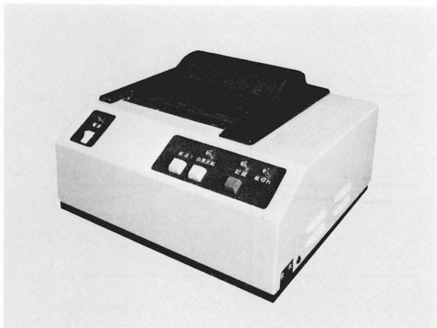
図11 ハードコピー装置の外観 簡便な記録装置とするため、コンパクトなサイズにまとめてあり、卓上に置いて使用することができる。
