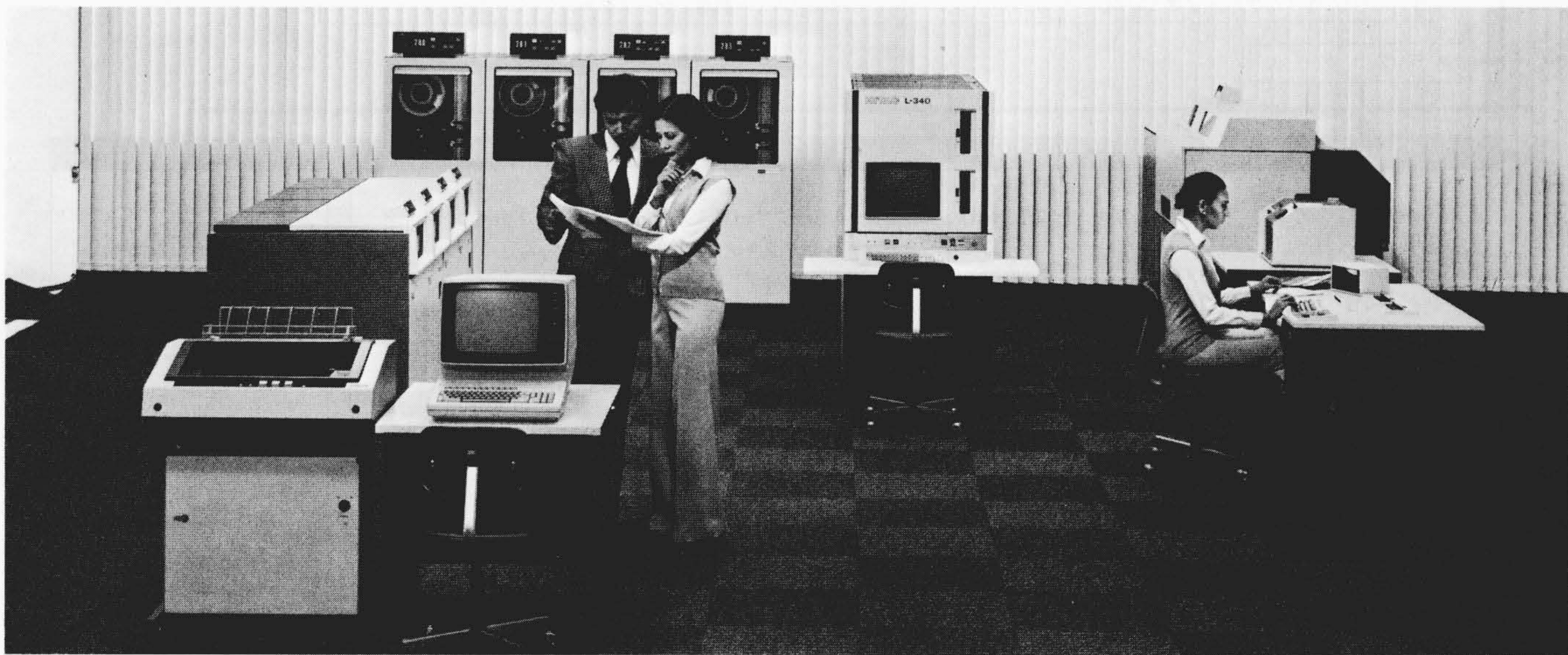
図1 L-340システム 高速大容量ディスク70MB×4スピンドルを接続した構内オンライン構成を示す。
