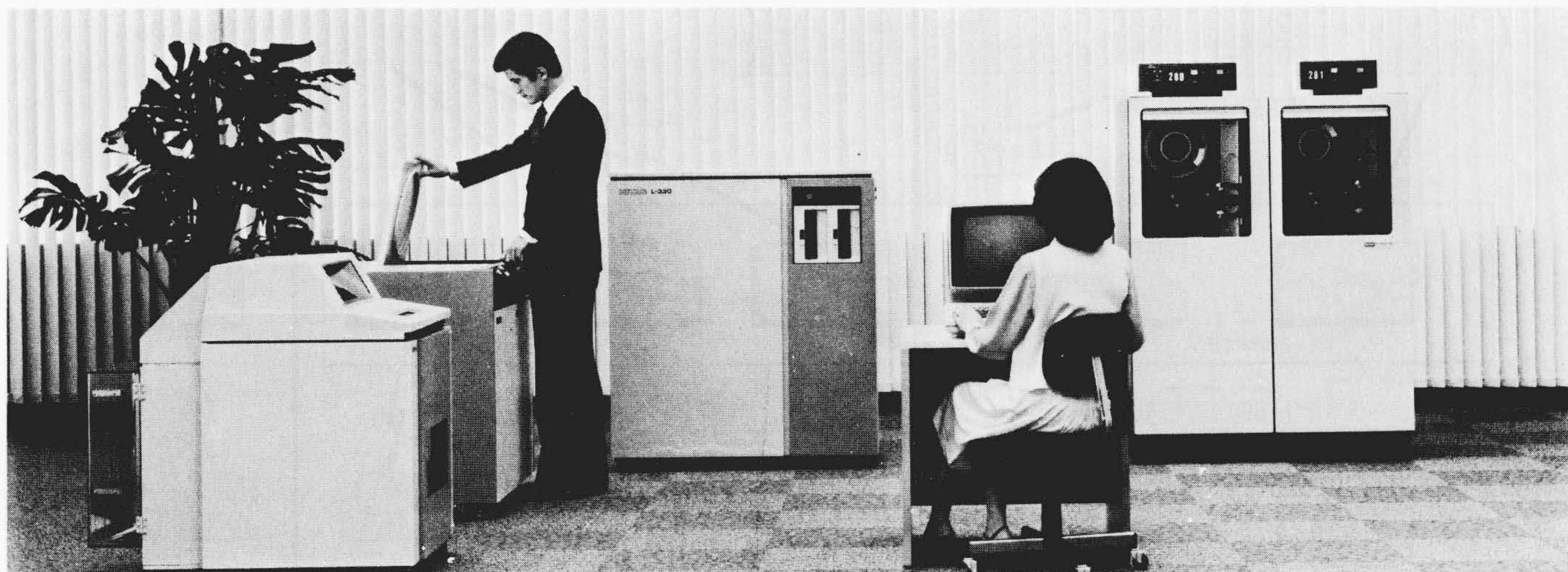
図1 L-330システム 磁気テープ装置の接続により、大量データの処理も可能なシステムである。
