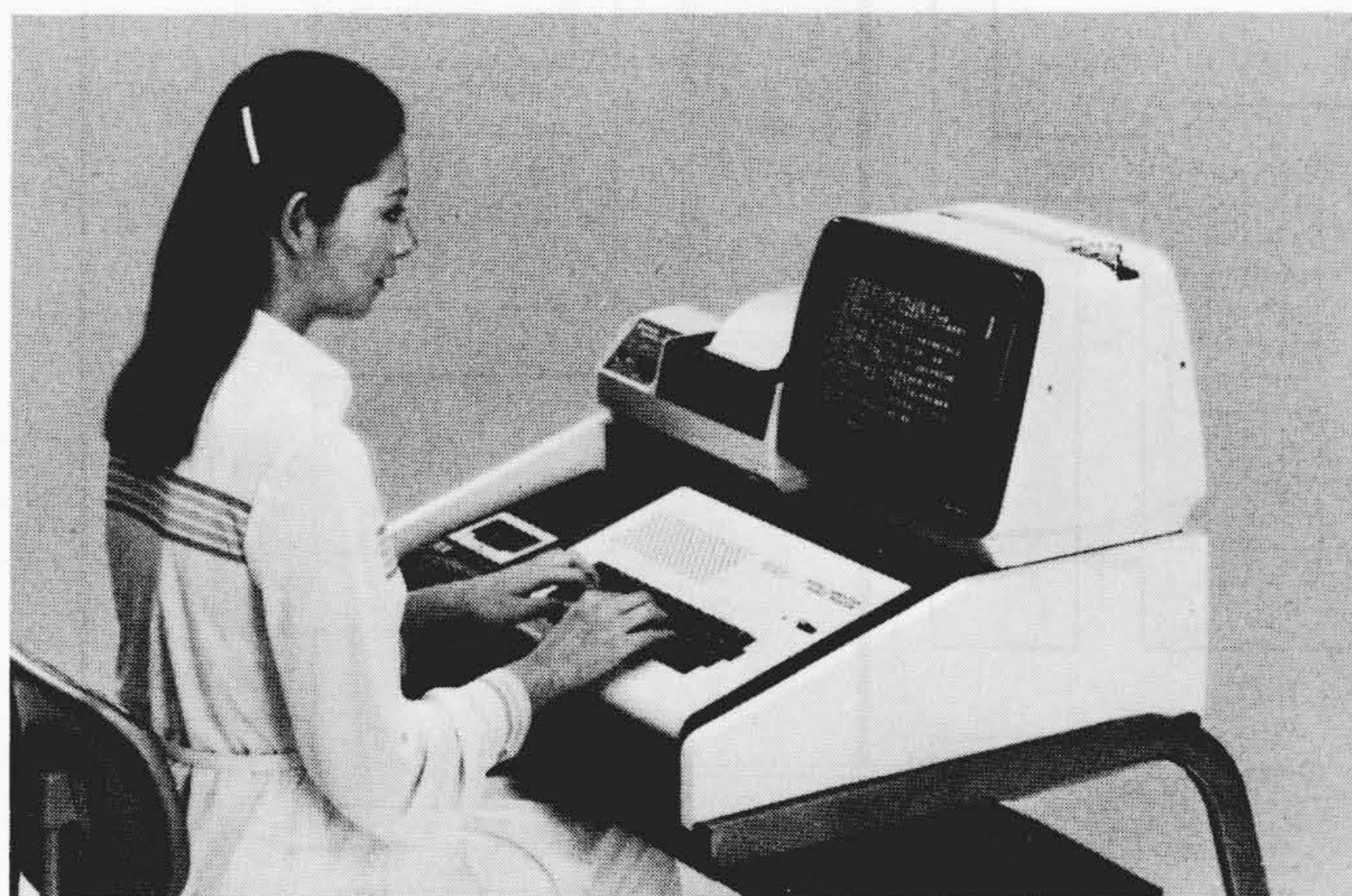
図1 「ベーシックマスター」の外観 標準の入出力装置として、家庭用テレビジョン又は専用キャラクタ・ディスプレイとカセットテープレコーダを使用する。
