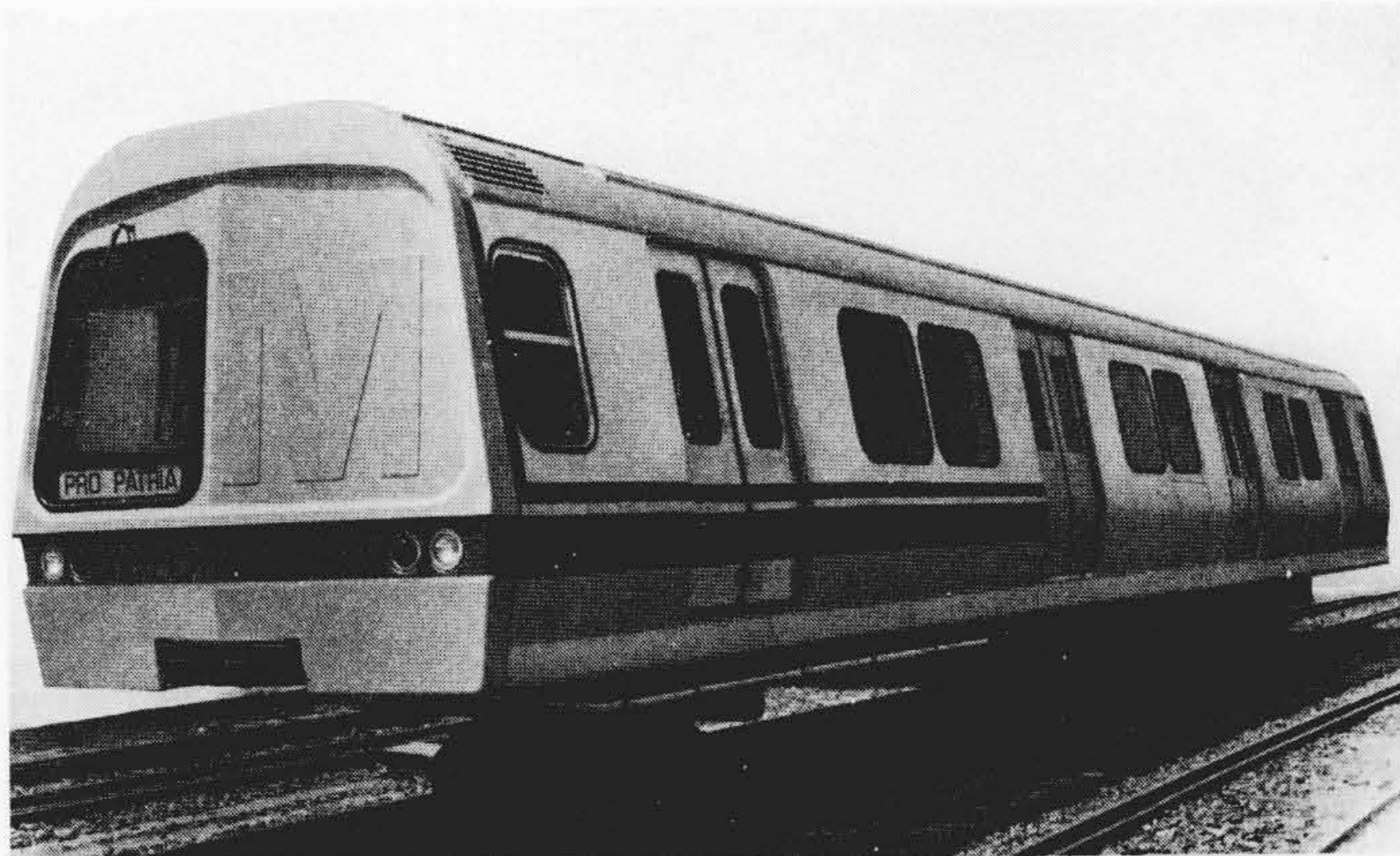
図2 軽量車体の外観 車長21m、車幅3mのアルミ合金製の構体に、FRP製前頭部をボルトにより結合している。
