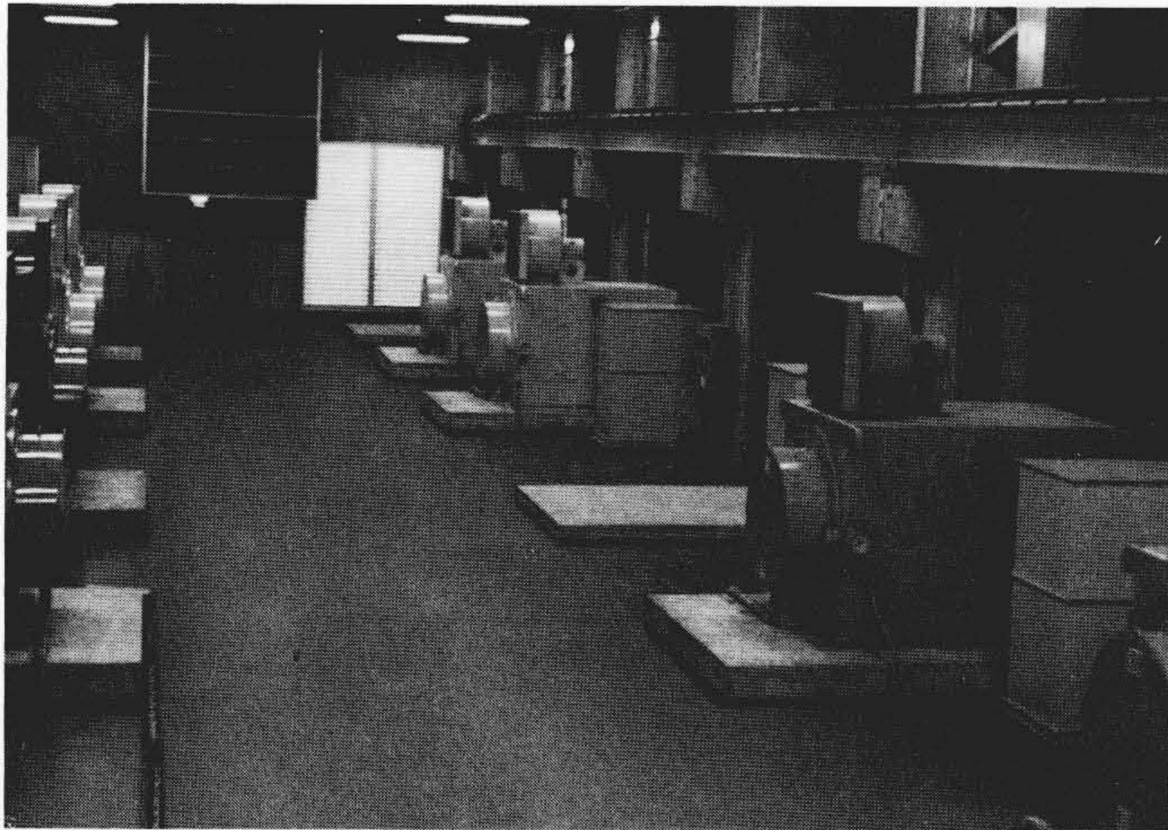
図3 サイリスタモータの外観 ブラシレス励磁機，交流速度発電機及び非接触形位置検出器により完全なブラシレス構造としてある。
