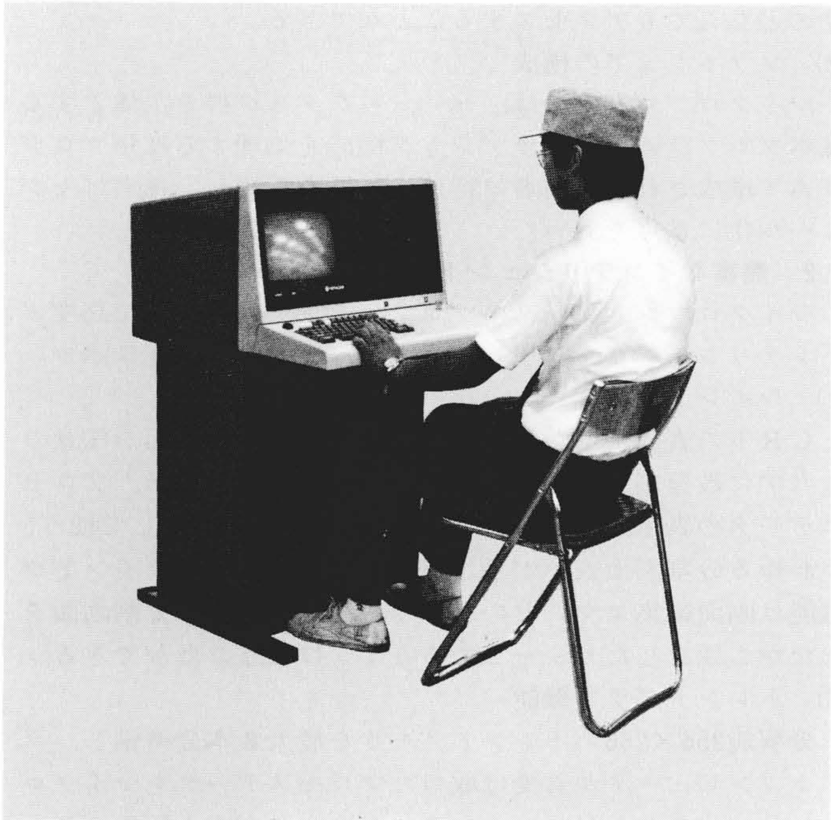
図11 コンソール入出力装置H-7026C CRTディスプレイ装置とフロッピディスク装置とを組み合わせ、一体化したコンソール入出力装置である。
