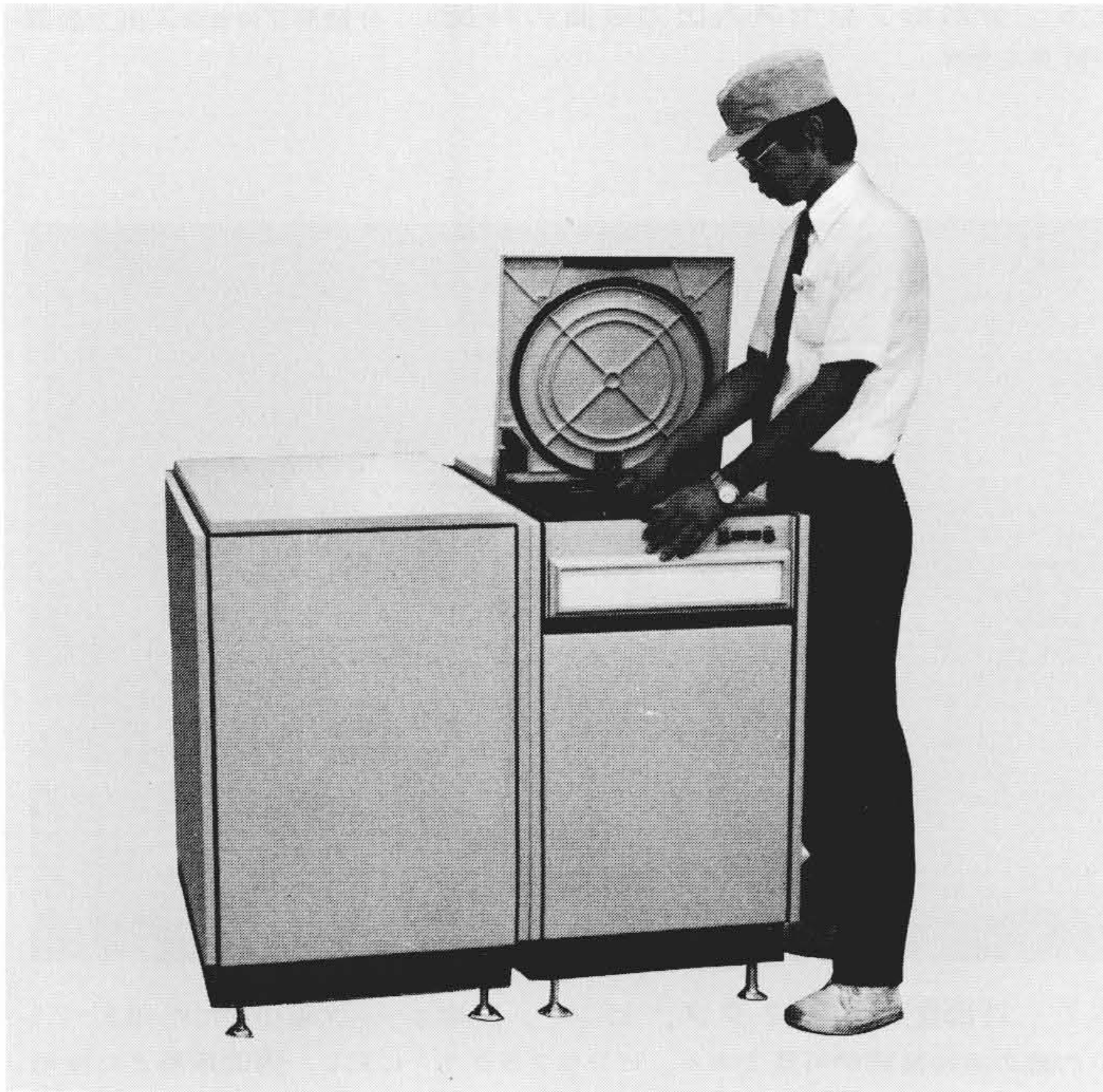
図8 H-7131C形大容量ディスク装置 右側がディスク駆動装置の筐体、左側が制御回路の実装されているフォーマッタ筐体を示す。
