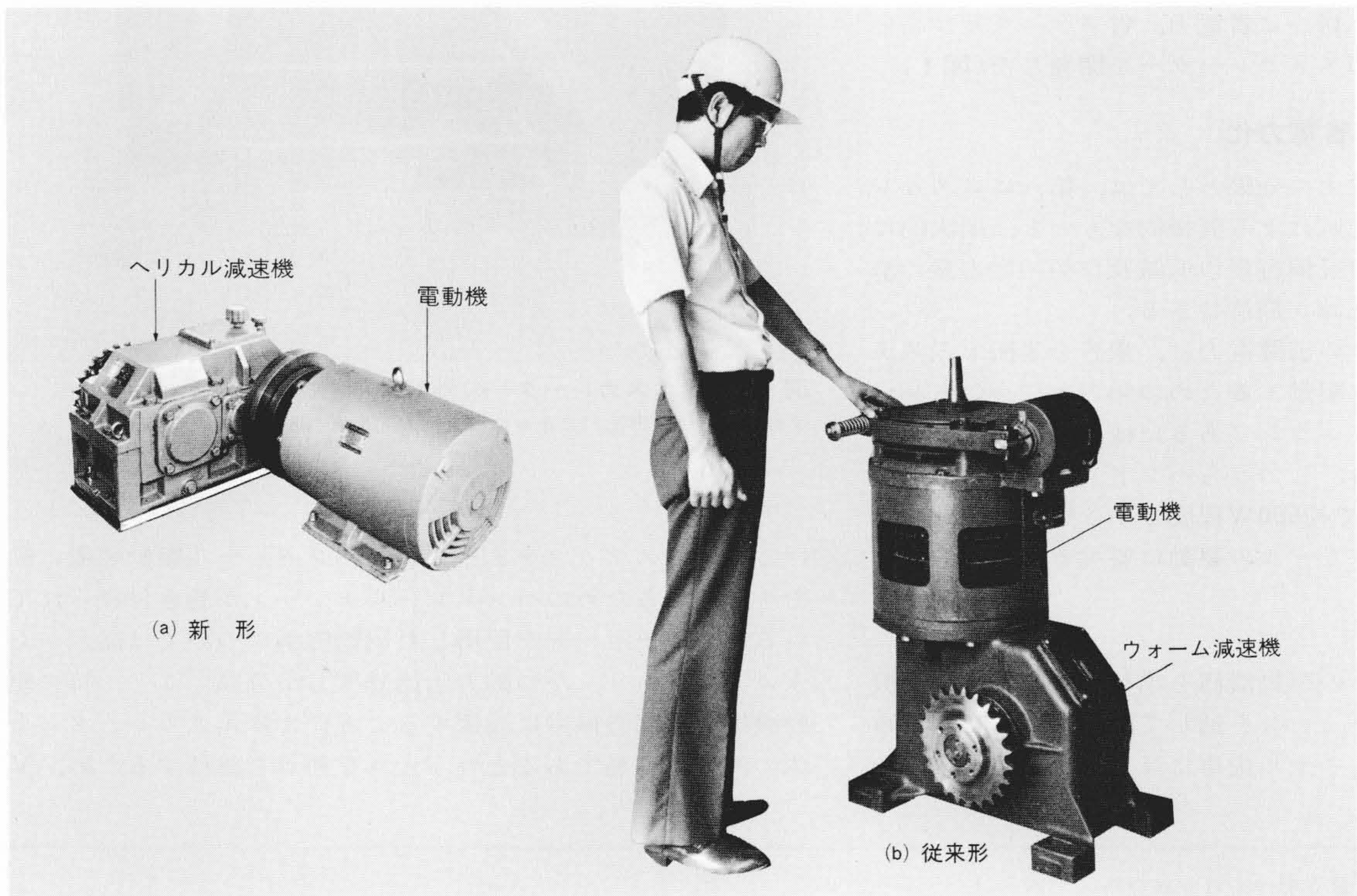
図3 新旧駆動機械の構造 新形はヘリカル歯車と横形電動機の組合せにより、従来のウォーム減速機に比べ体積、重量とも約20%低減している。
