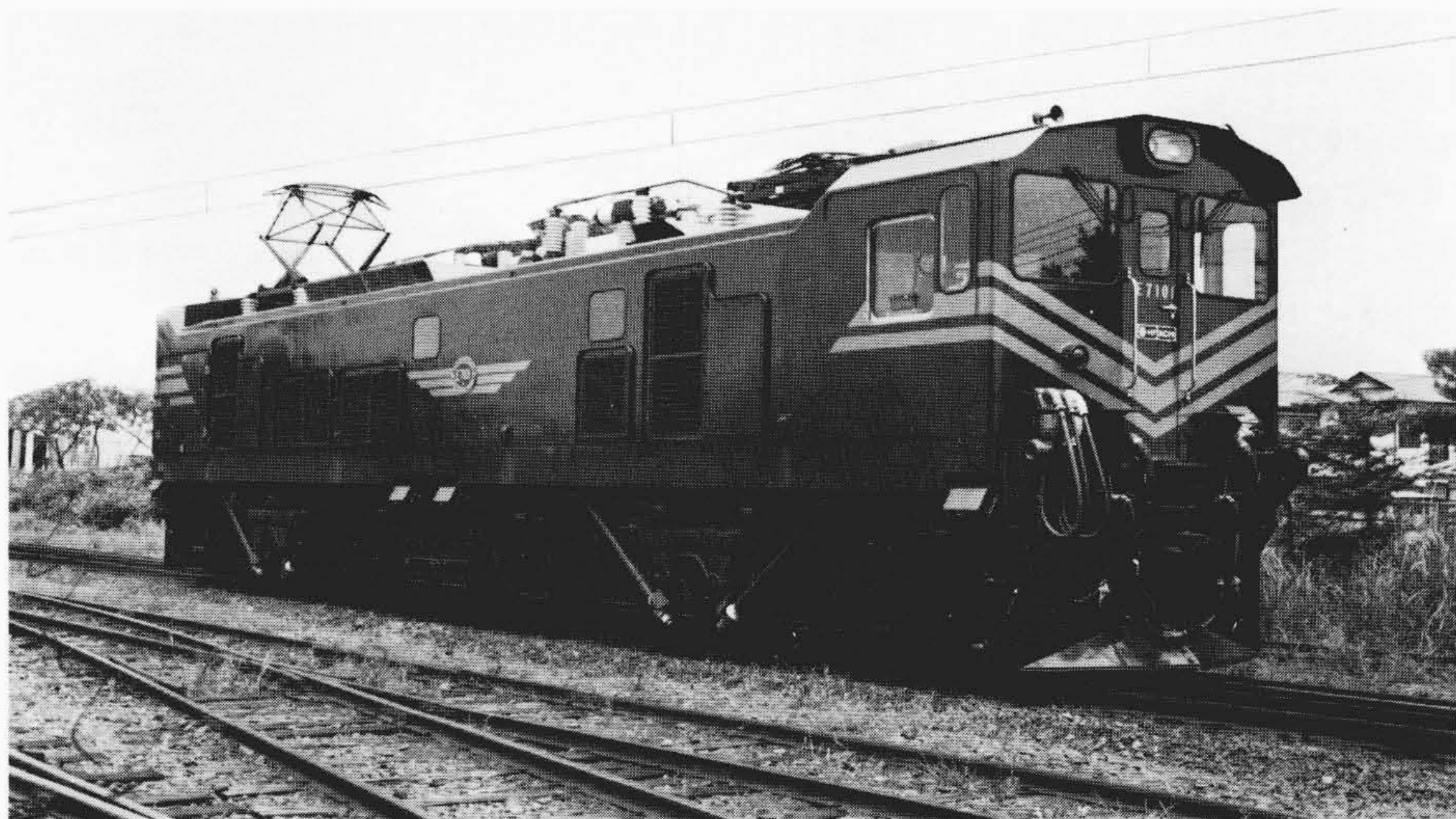
図4 3,000kWサイリスタ式交流電気機関車の外観
