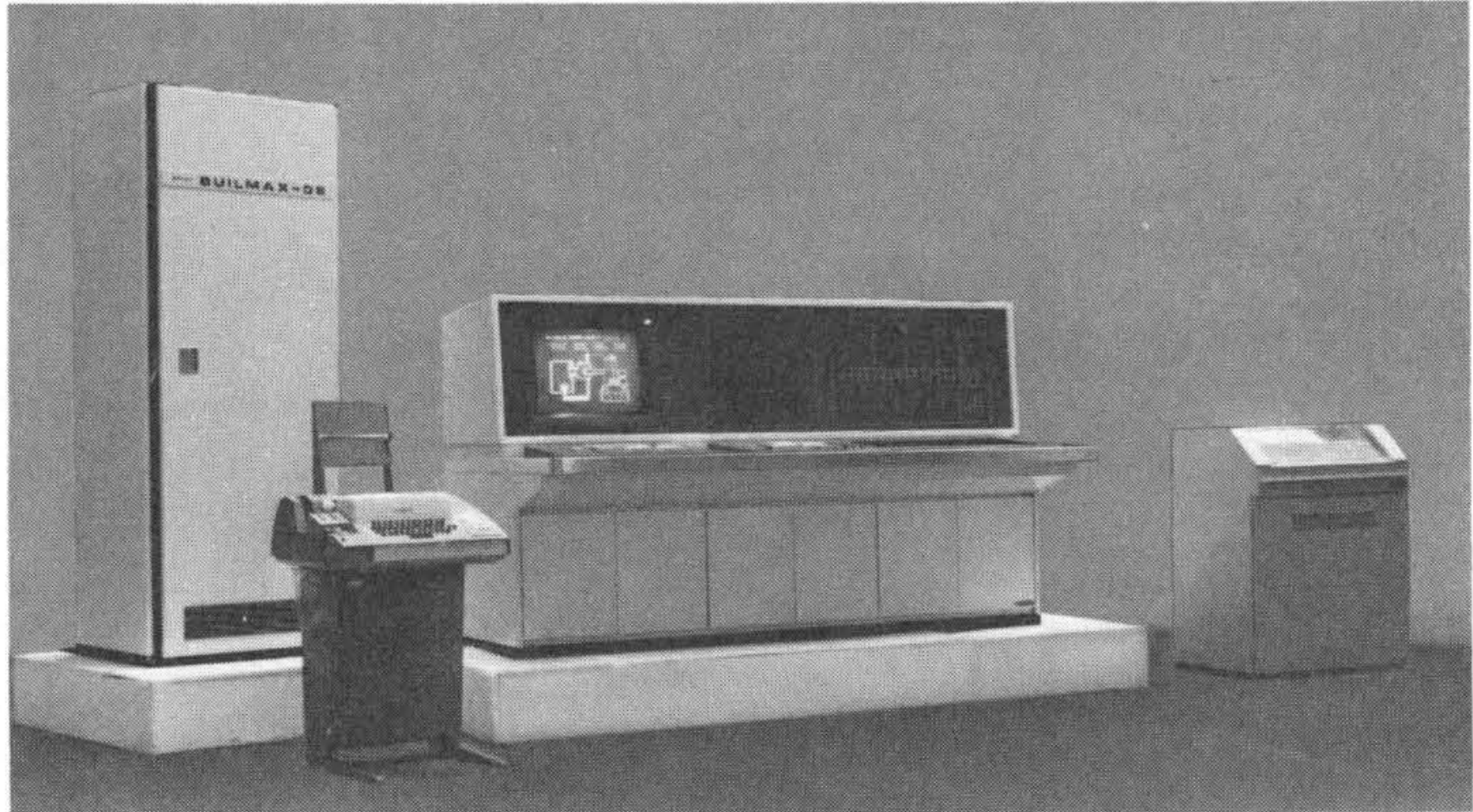
図4 “BUILMAX-08”構成機器 “BUILMAX-08”の中央監視操作卓、中央処理装置、動作故障記録タイプライタ及び 日報作成用タイプライタを示す。
