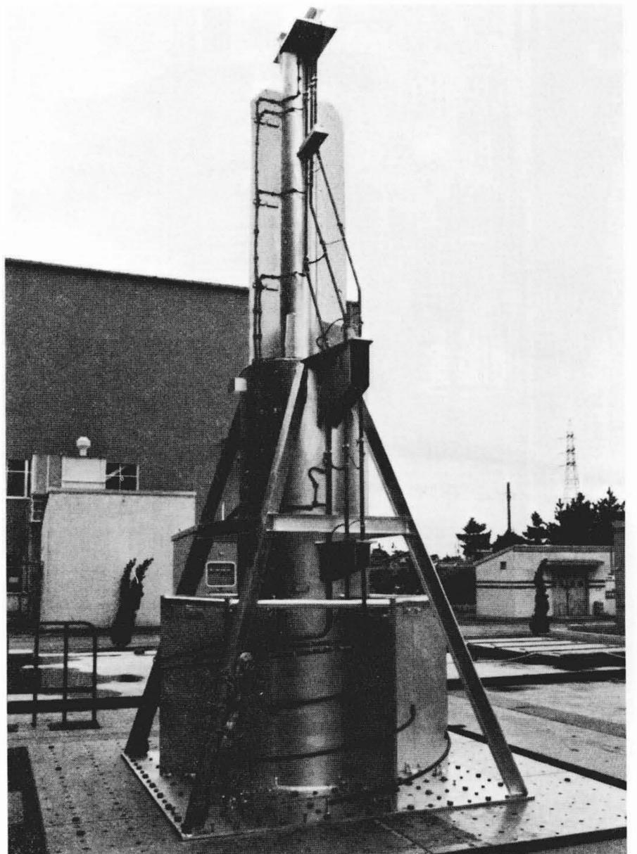
図9 蒸気発生器の振動試験体モデル 伝熱管の上昇管とヘリカルコイルの一部を模擬したモデルにより、各種地震波の試験が行なわれ、設計に反映されている。
