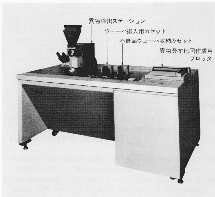
図10 LSIウェーハ異物自動検出装置の外観 カセットに収納したウェーハが異物検出ステーションに自動的に搬送され、ウェーハ上の $2 \sim 3 \mu\text{m}$ 以上の異物がタクト1.5分で自動的に検出される。
