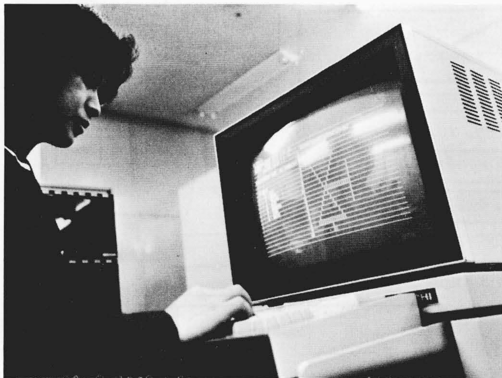
図1 CRTとの会話による作画 CRTのスクリーンとキーボードを使用して、表示イメージでの確認を行ないながら作画することができる。
