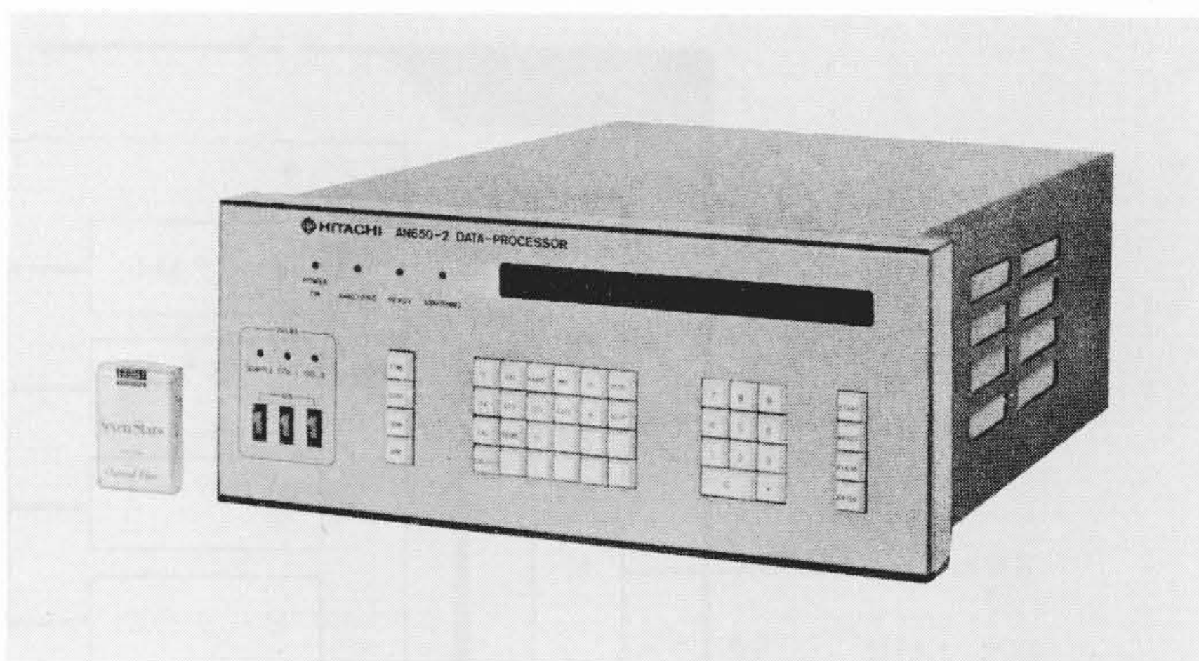
図9 AN650-2DP形プロセスガスクロマトグラフデータプロセッサの外観 装置前面にオペレータコンソールを配置し、対話形式で設定値の入力、変更などが行なえる〔外形寸法：幅480×高さ200×奥行565(mm)〕。
